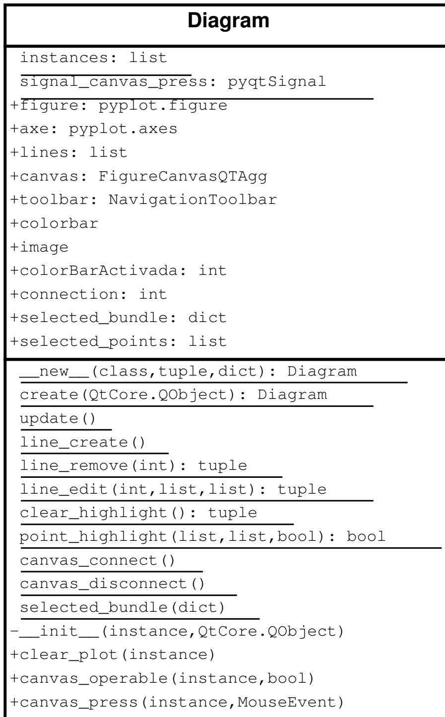
Figura 10.7: Diagrama de la clase Diagram con notación UML.
