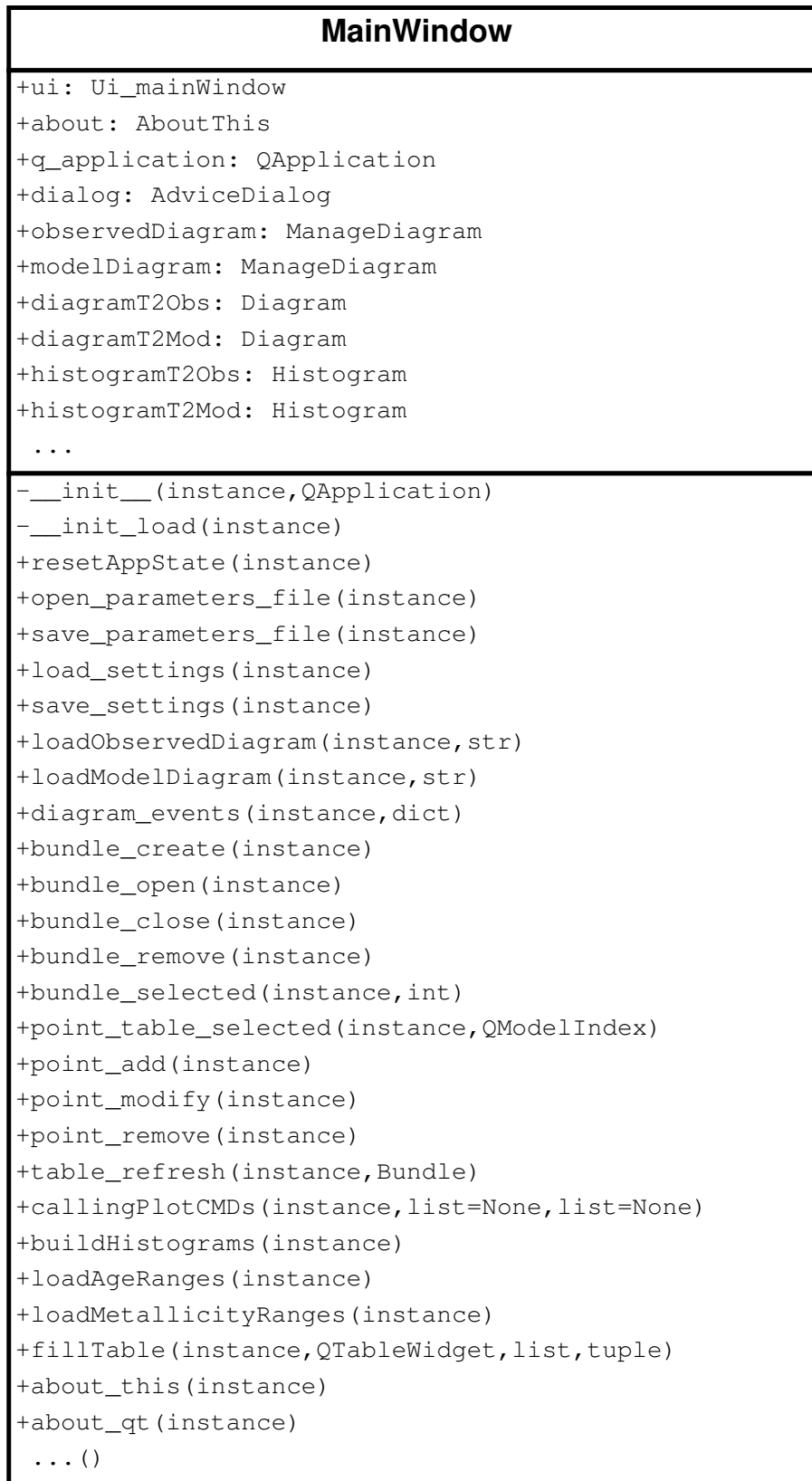
Figura 10.5: Diagrama de la clase MainWindow con notación UML.
