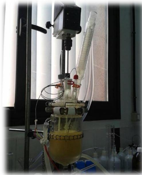
*Figura 4.9: Reactor durante la deslignificación*
