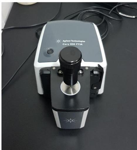
Figura 4.10: Equipo de espectroscopía infrarroja
