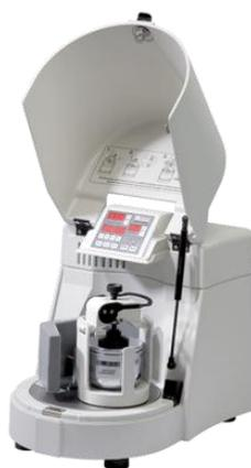
Figura 4.5: Molino de bolas Pulverisette 6 “classic line”
