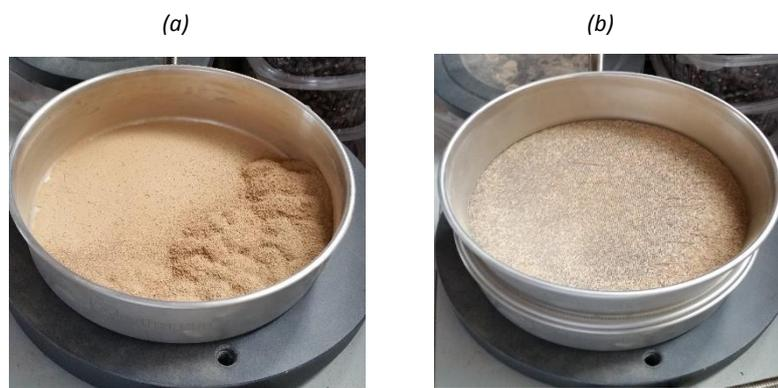
Figura 4.7: (a) Tamaño inferior a  $500\ \mu\text{m}$ ; (b) Tamaño superior a  $500\ \mu\text{m}$
