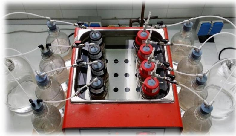
Figura 4.12: Digestores montados
