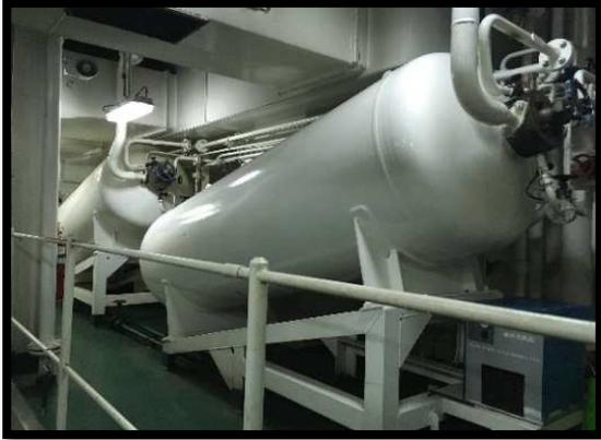
**Ilustración 68: Botellas aire de arranque MMPP.**
