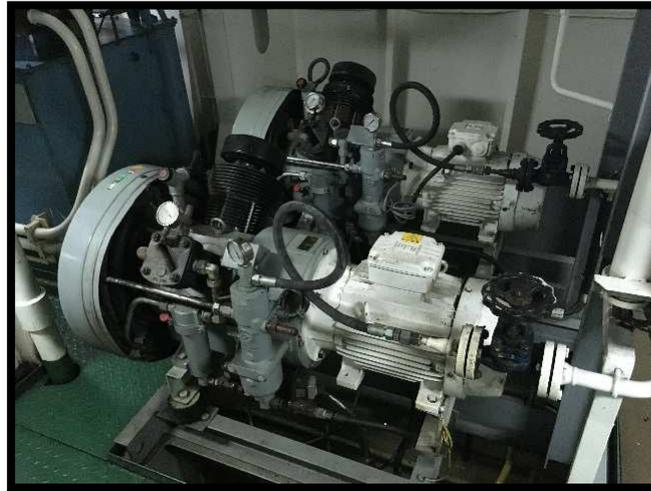
**Ilustración 66: Compresores de aire de arranque.**
