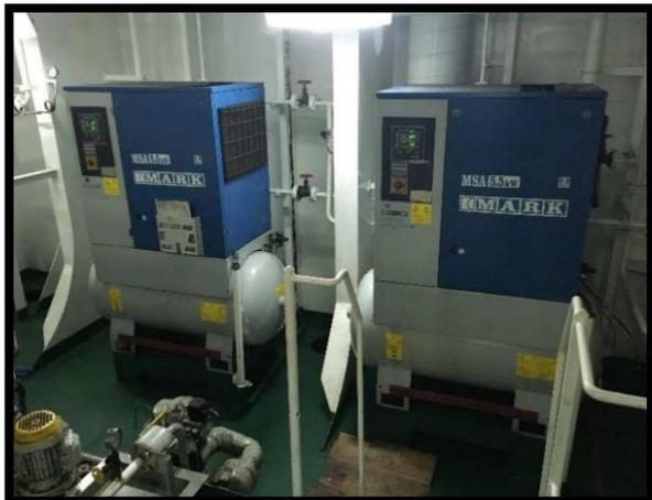
**Ilustración 70: Compresores de aire de baja.**
