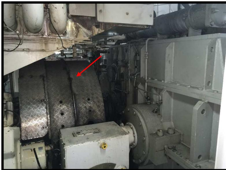
**Ilustración 14: Acople entre el motor a la reductora.**
