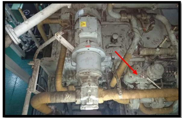
**Ilustración 15: Reductora REINTJES BV-K70629/2007-02.**
