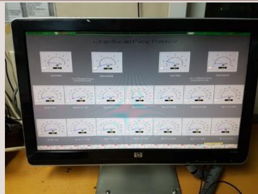
Monitorización de las presione, temperatura y vacios de los tanques
