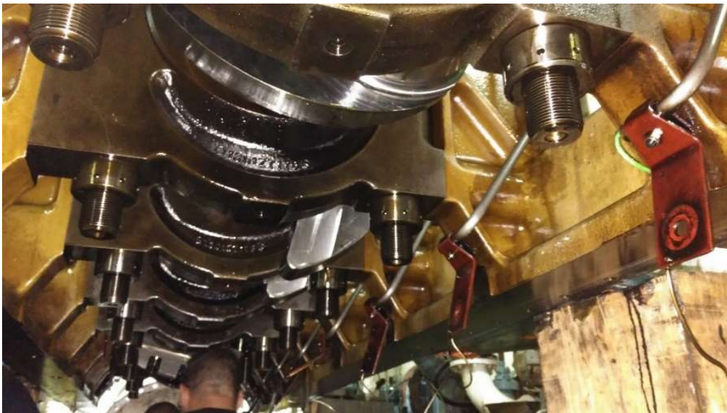
Ilustración 74. Apriete de las tuercas de presión de los asientos de bancada. Fuente: Trabajo de campo.
