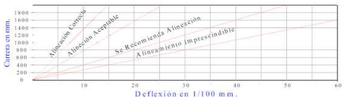
Ilustración 54. Tabla ejemplo de la deflexión de un cigüeñal. Fuente: [13].
