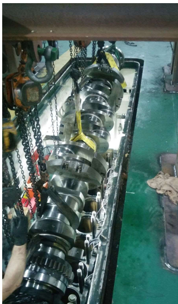
Ilustración 71. Extracción del cigüeñal por la lumbrera de la cubierta principal. Fuente: Trabajo de campo.
