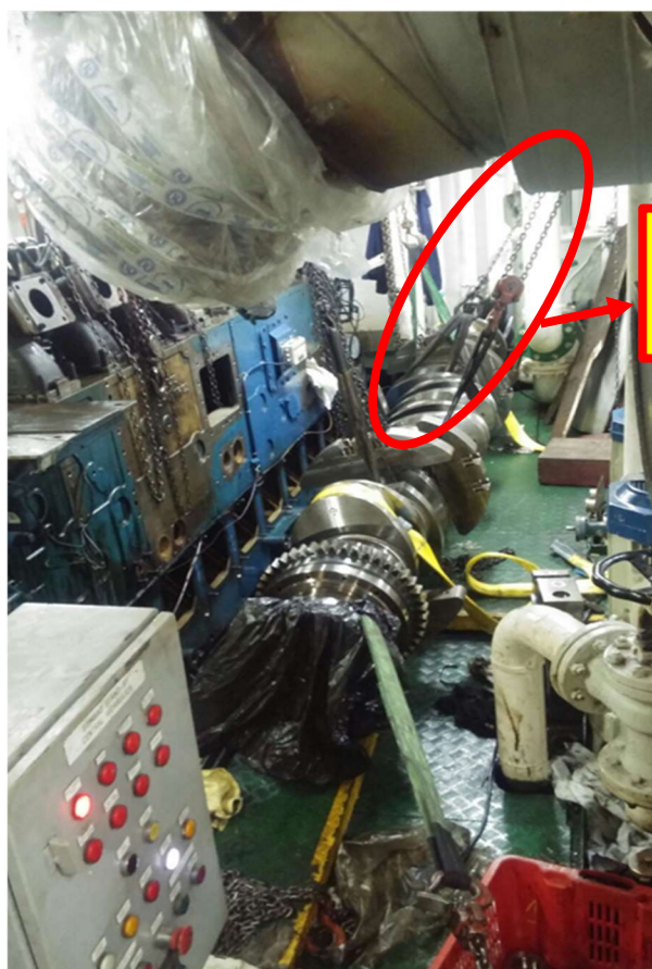
Ilustración 70. Maniobra de extracción del cigüeñal averiado. Fuente: Trabajo de campo.
