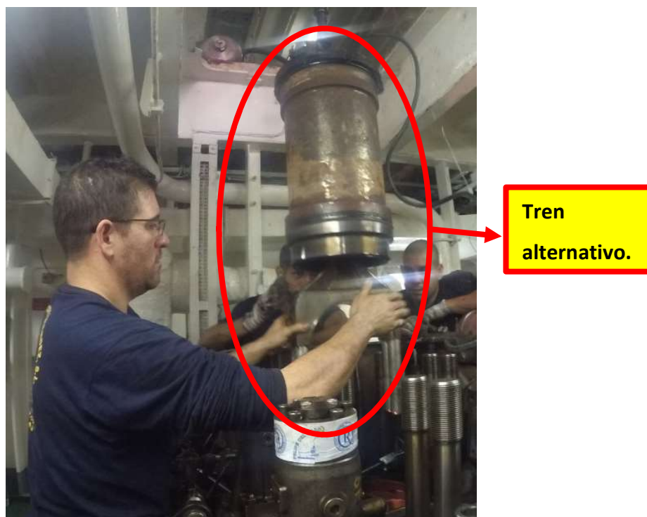
Ilustración 23. Extracción tren alternativo. Fuente: Trabajo de campo.
