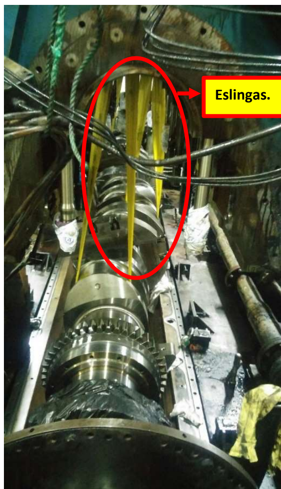
Ilustración 69. Maniobra de arriado del cigüeñal. Fuente: Trabajo de campo.
