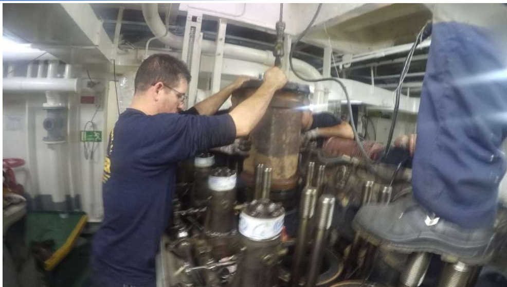
Ilustración 43. Maniobra extracción camisas. Fuente: Trabajo de campo.
