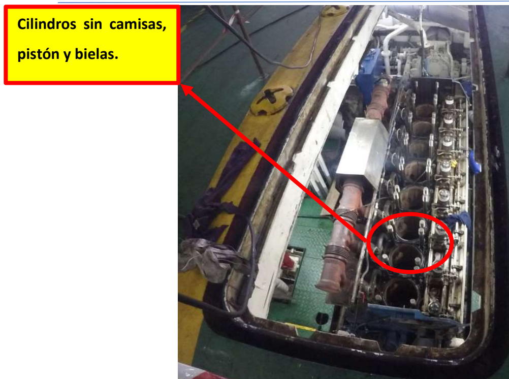
Ilustración 24. Vista superior del motor con los trenes alternativos desmontados. Fuente: Trabajo de campo.
