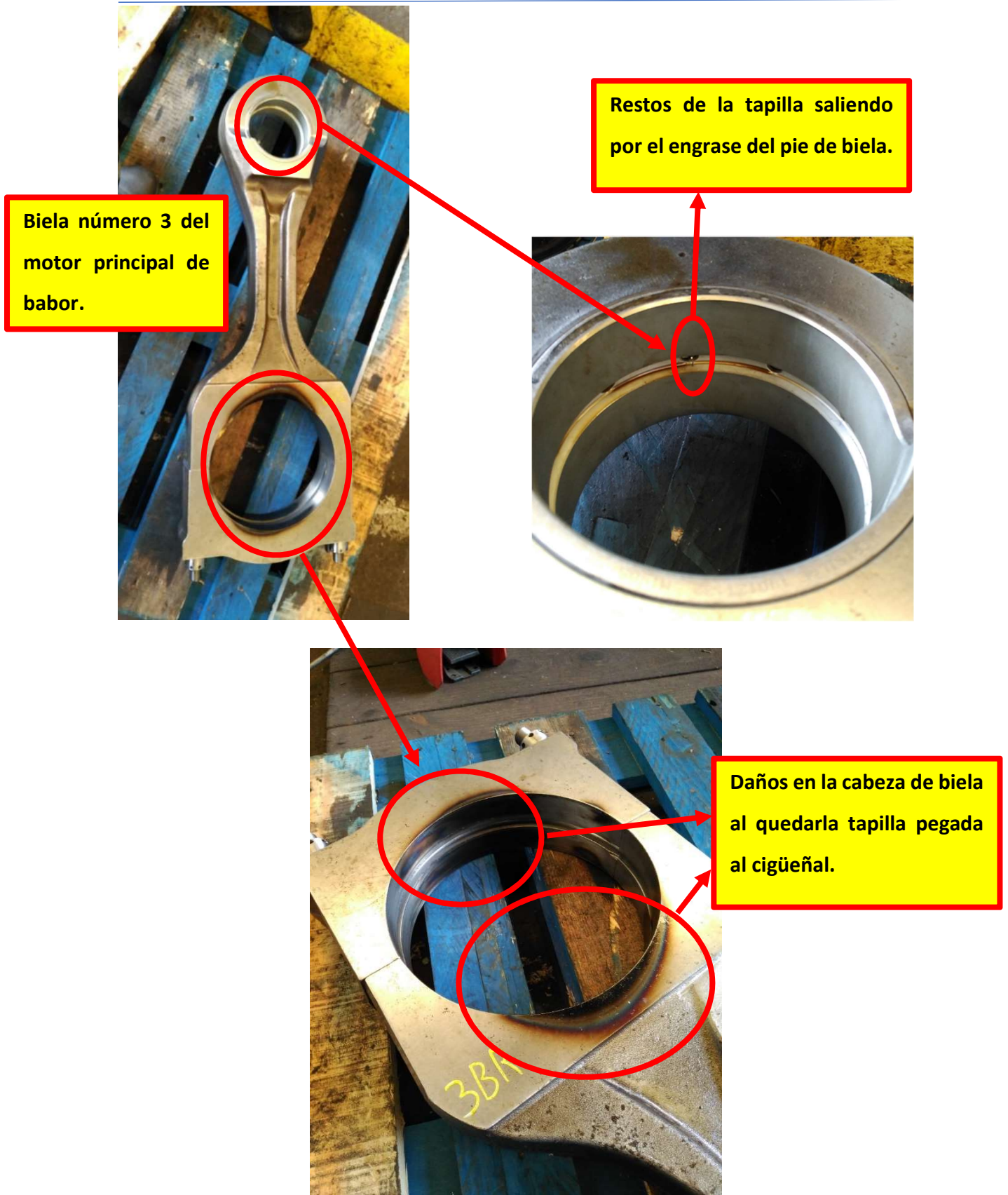
Ilustración 56. Detalle de los daños en la biela. Fuente: Trabajo de campo.
