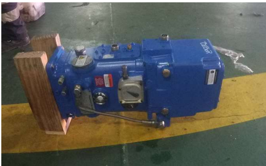
Ilustración 26. Regulador del motor principal. Fuente: Trabajo de campo.
