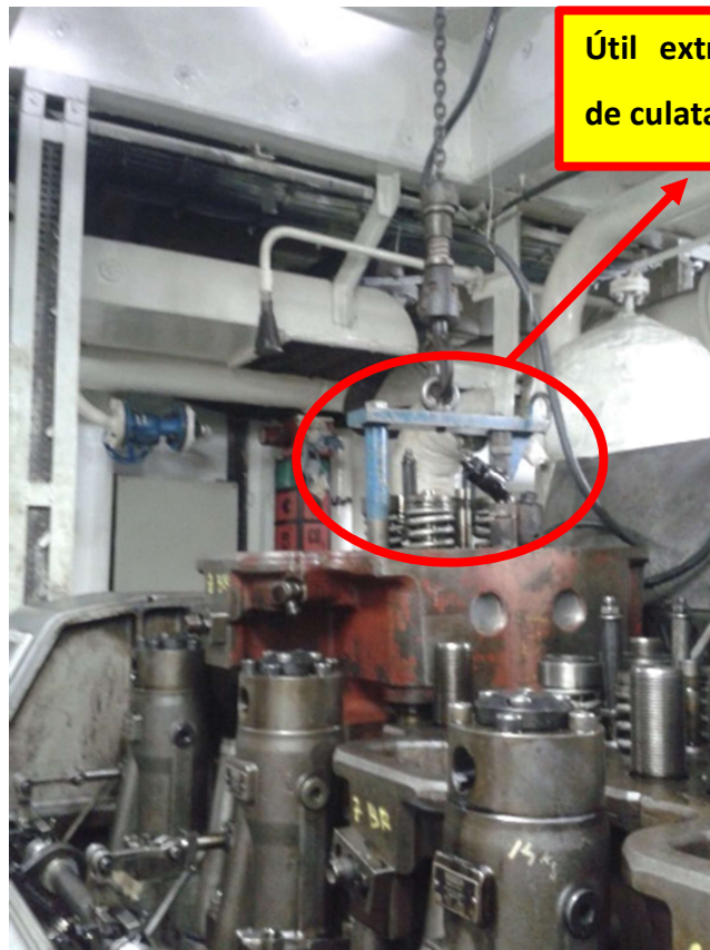
Ilustración 34. Extracción de culatas. Fuente: Trabajo de campo.
