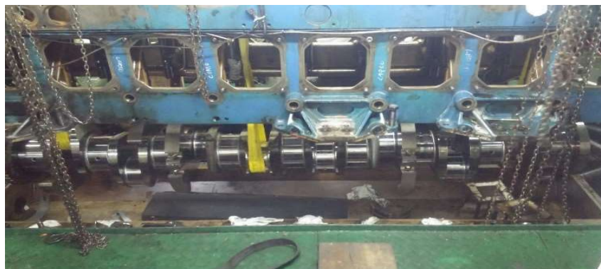
Ilustración 73. Maniobra de introducción del cigüeñal en el bloque 2. Fuente: Trabajo de campo.
