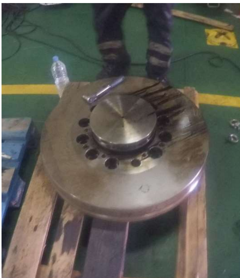
Ilustración 48. Damper Antivibración desmontado. Fuente: Trabajo de campo.
