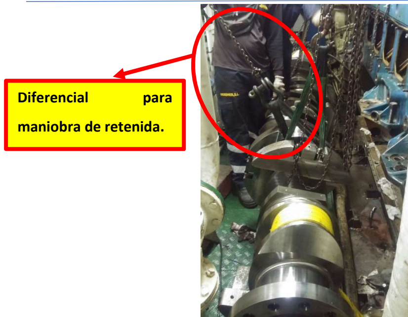
Ilustración 72. Maniobra de introducción del cigüeñal en el bloque. Fuente: Trabajo de campo.
