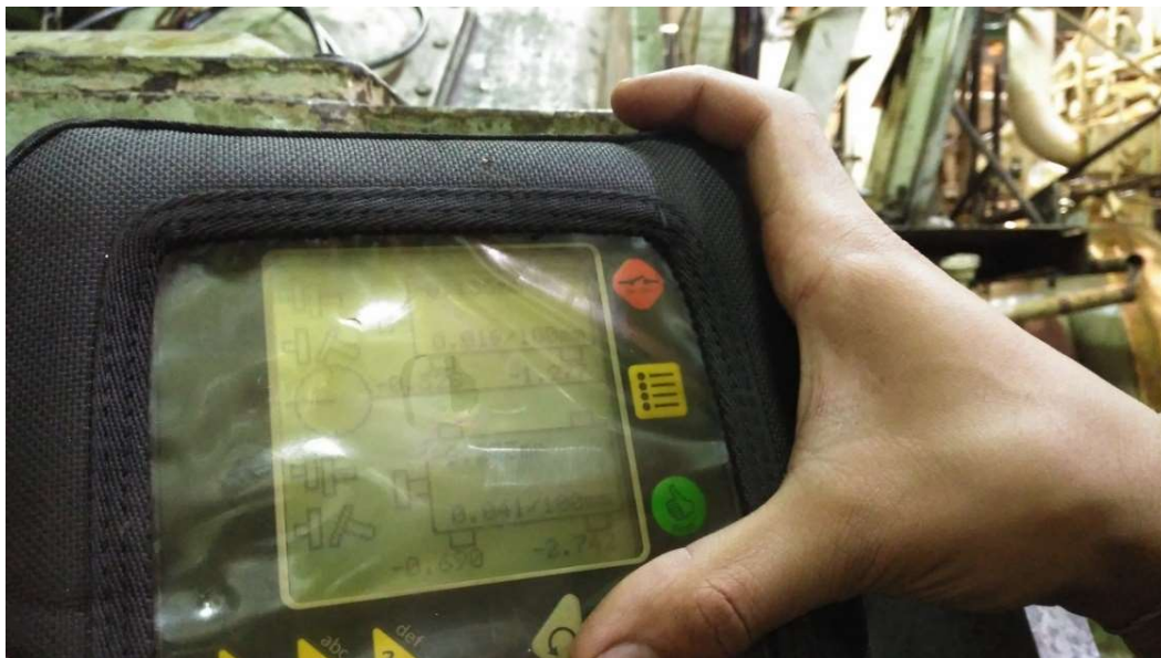
Ilustración 79. Sistema de alineación láser, empleado para alinear el motor. Fuente: Trabajo de campo.
