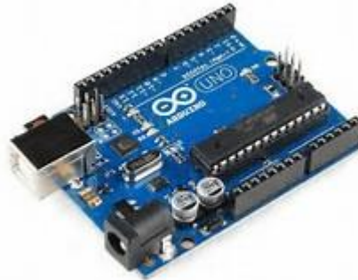
Figura 3.13: Placa Arduino UNO
