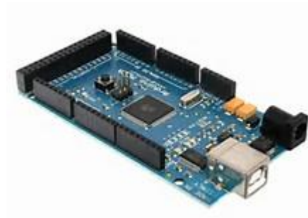
Figura 3.14: Placa Arduino MEGA
