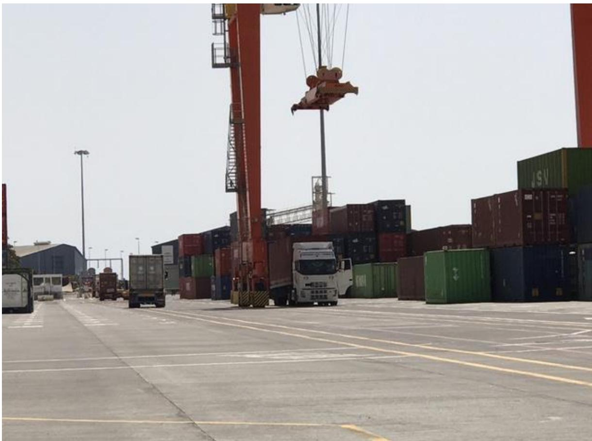
*Ilustración 5. Grúa de patio colocando contenedor en un camión.*
