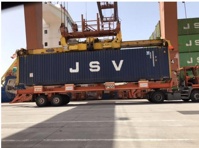
Ilustración 3. Grúa de barco descargando contenedor en maffi.
