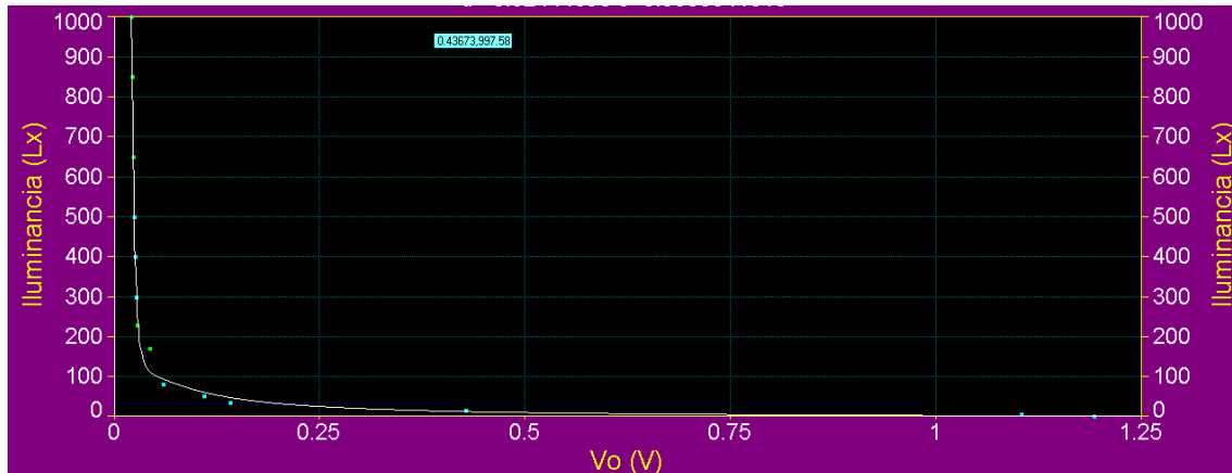
Figura 22: Sensor LDR. Curva de calibración Iluminancia - Vo
