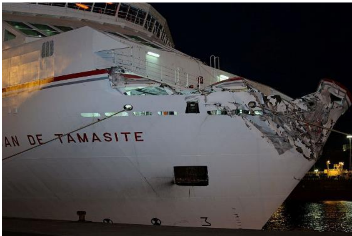
Ilustración 56. Daños causados en la proa del buque. Fuente: https://es.wikipedia.org/wiki/Accidente_del_Volc%C3%A1n_de_Tamasite_en_Las_Palmas_de_Gran_Canaria
