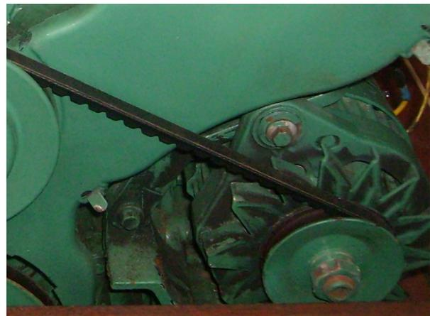
25. Tornillos sujeción alternador
