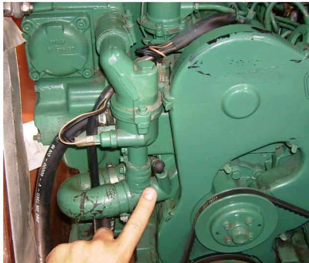
27. Tubería de vacío para el aceite motor
