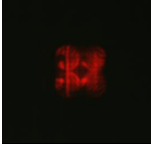
Figura 2.20. Detalle de una imagen de medida. Se observa la respuesta del sensor plenóptico ante una fuente puntual medida a través de una aberración de fase de frente de onda. En este caso, el tamaño de la imagen en el plano focal es tal que solo produce intensidad en el área subtendida por cuatro microlentes.
