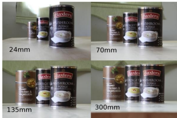
Figura 5.5. Efecto de la variación de la longitud focal en la perspectiva. Fuente: expertphotography.com
