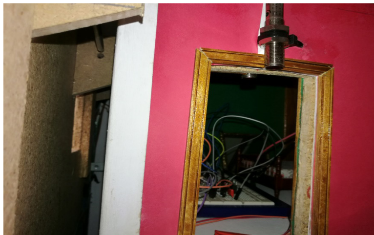
Figura 4.19: Sensor fotoeléctrico en umbral de la puerta de la habitación.
