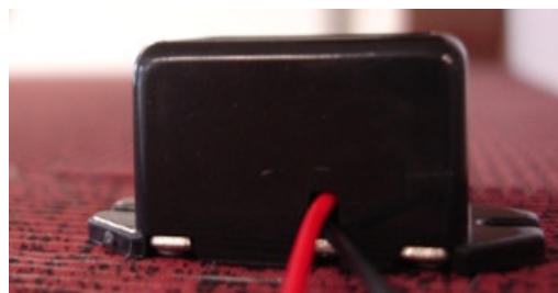
Figura 4.34. Zumbador de la casita domótica.(extraído de [1])
