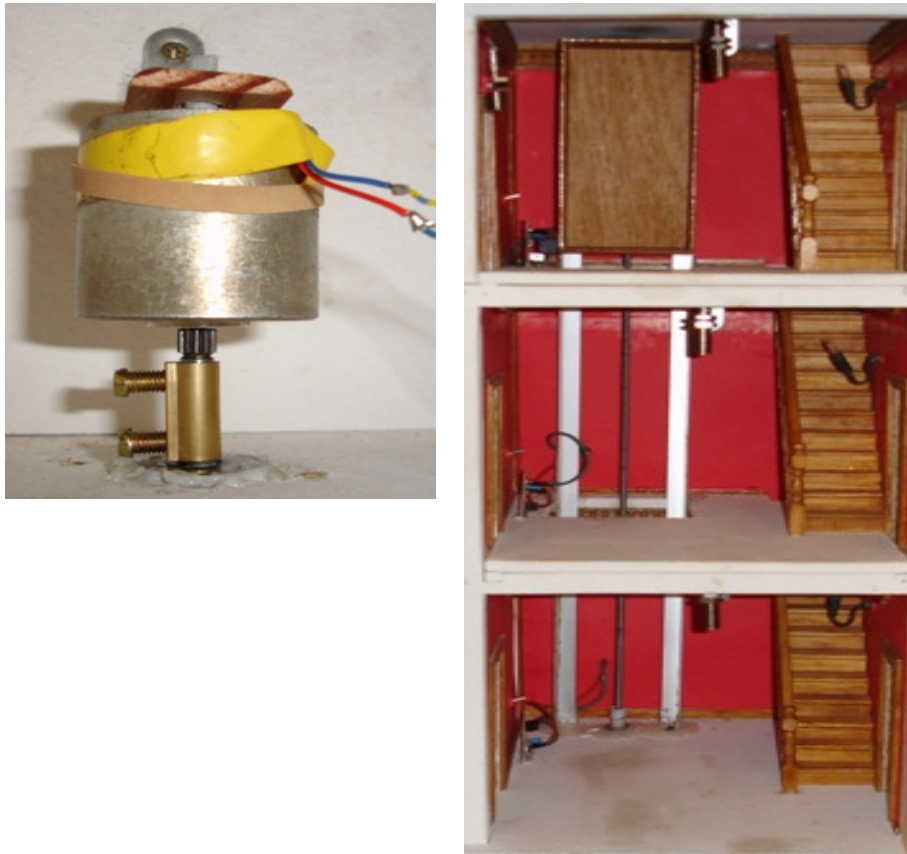
Figura 5.3. Motor del ascensor unido al tornillo sinfín (izquierda) y estructura del ascensor (derecha). (Extraído de [1])
