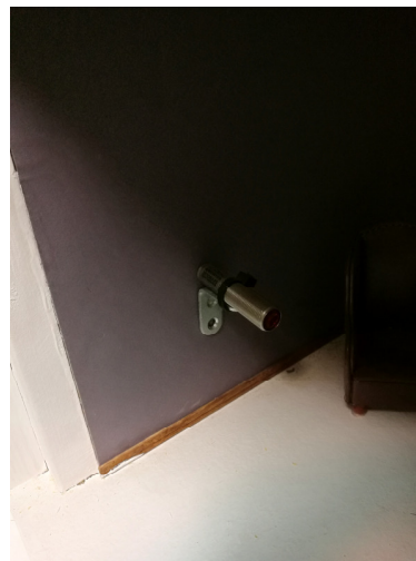
Figura 4.21. Sensor fotoeléctrico para detección de intrusos
