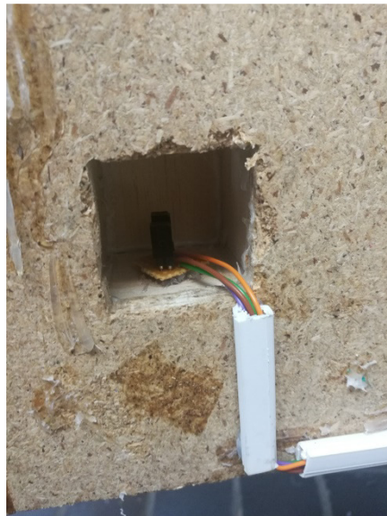
Figura 4.41. Optoacoplador para llevar el conteo de cartas en el buzón
