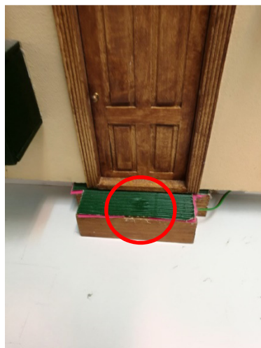
Figura 4.47 Sensor de presencia en entrada principal (bajo alfombra)
