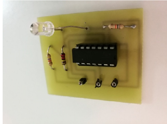
Figura 4.17. Esquema PCB creado con Orcad y visualizado con Gerber Viewer (izquierda). Circuito con fotodiodo final (derecha).
