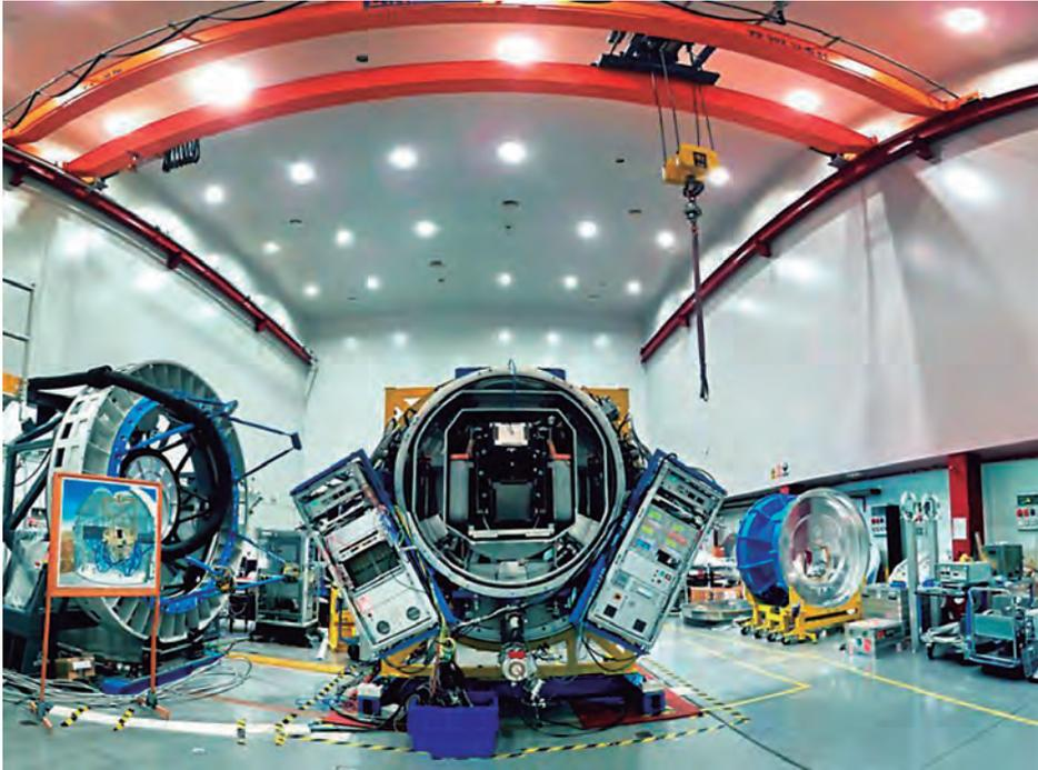
Imagen 16. EMIR, Espectrógrafo Multiobjeto InfraRojo, es un espectrógrafo de gran campo que trabajará en el rango del infrarrojo cercano y podrá obtener información de numerosos objetos a la vez. Es el primer instrumento de segunda generación del *Gran Telescopio Canarias (GTC)* y será clave para el estudio de la historia de la formación de estrellas en el universo. (Créditos: Pablo López/IAC).
