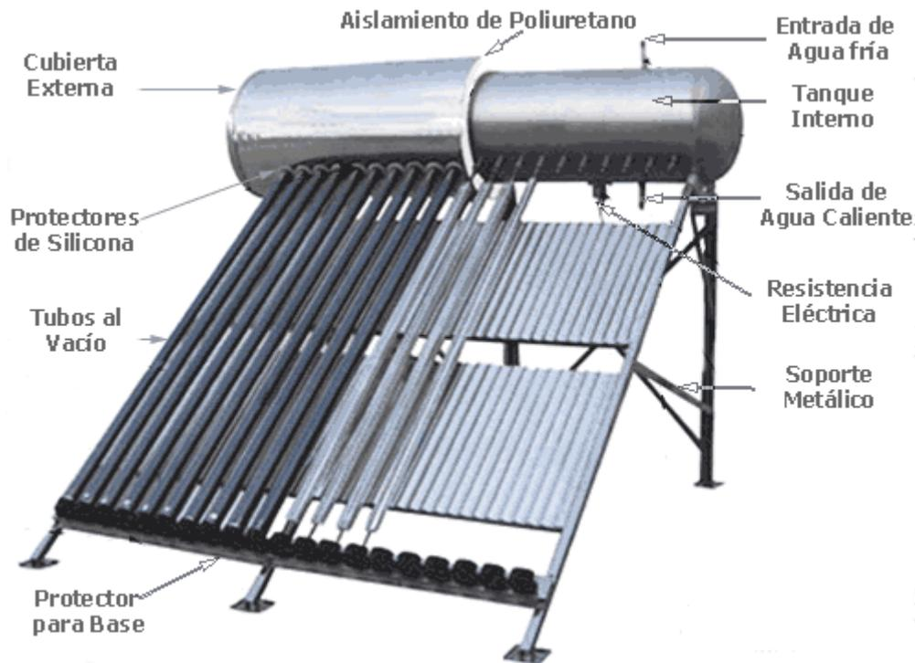
Figura 5. Partes de un colector de vacío. Fuente: [www.suelosolar.com](http://www.suelosolar.com)
