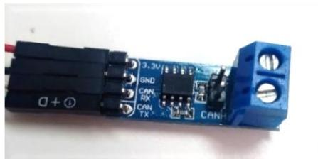
Ilustración 14. Adaptador basado en SN65HVD230.
