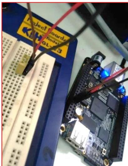
*Ilustración 51. Circuito entradas analógicas BBB.*
