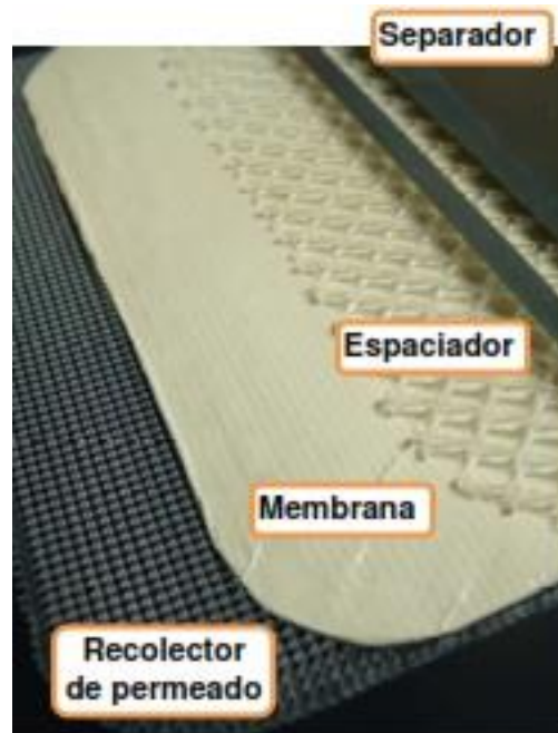
Figura 17. Elementos internos de la celda
