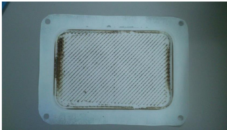
Figura 28. Estado de la membrana al final del experimento con una velocidad de 0,35 m/s (96 horas de operación).
