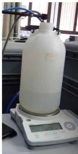
Figura 19. Sistema de recogida de permeado.
