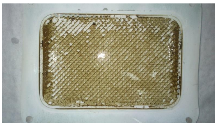
Figura 30. Estado de la membrana al final del experimento con velocidad de 0,15 m/s(24 horas de operación).
