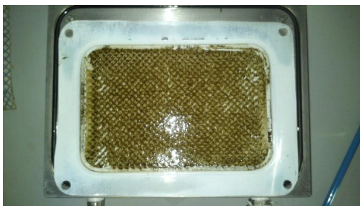
Figura 29. Estado de la membrana al final del experimento con una velocidad de 0,15 m/s (96 horas de operación).
