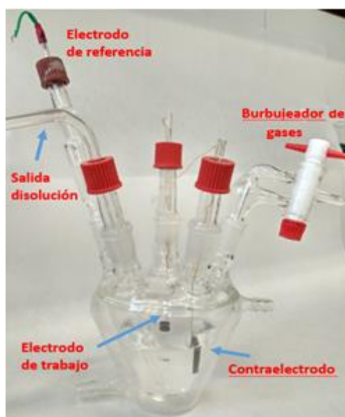
Figura 3.3. Celda electroquímica de seis bocas
