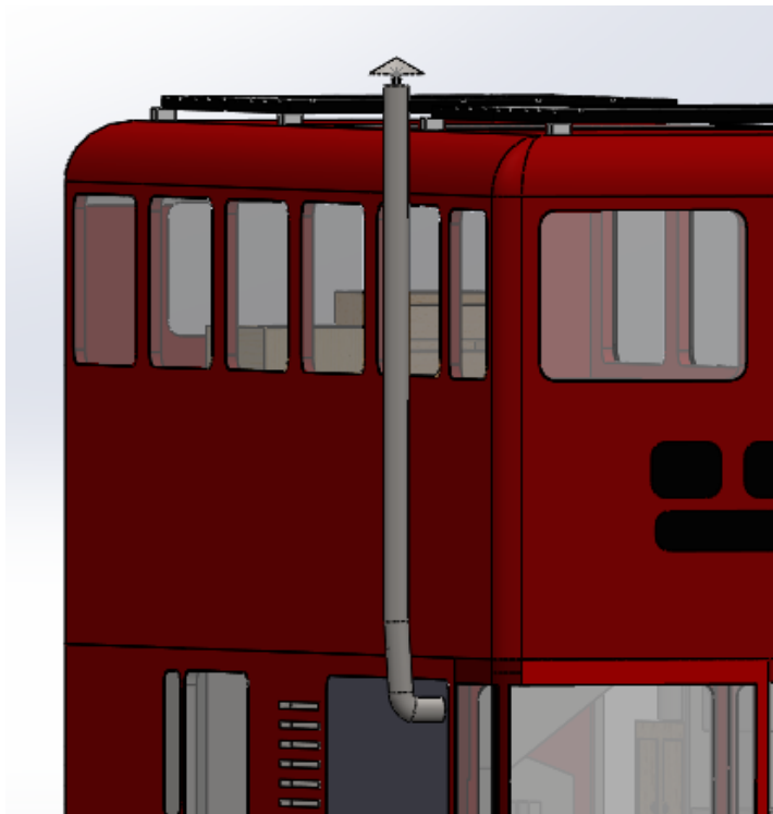
Figura 54. Chimenea de extracción de aire. Fuente propia
