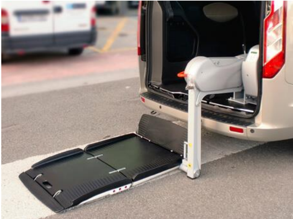
Figura 60. Rampa para minusválidos. Fuente: ibilkom.es
