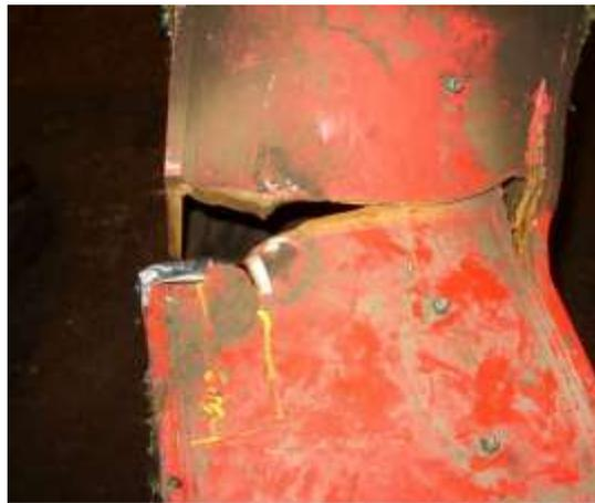
Figura 9. Corrosión bajo tensiones. Fuente: <http://www.cedinox.es/>
