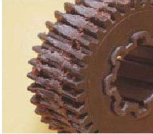
Figura 10. Corrosión por fricción. Fuente: <http://blog.utp.edu.co/>
