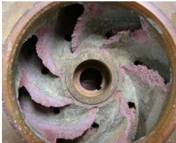
Figura 7. Corrosión por erosión. Fuente: <http://www.pairodocspro.com/>
