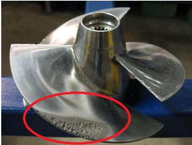
Figura 8. Corrosión por cavitación. Fuente: <http://blog.utp.edu.com/>
