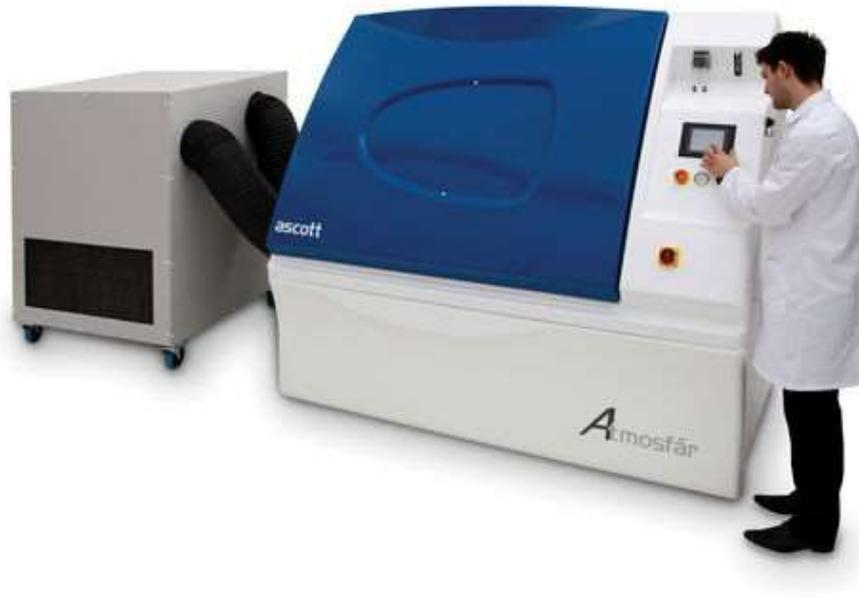
Figura 15. Ejemplo de una cámara de niebla salina en mercado. Fuente: Directindustry.com
