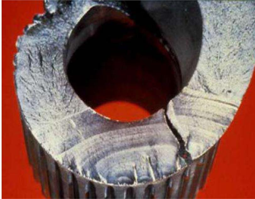
Figura 11. Corrosión por fatiga. Fuente: <http://endalloy.net/>
