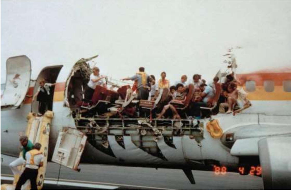
Figura 13. Foto del lado izquierdo del vuelo 243 de Aloha Airlines accidentado el 29 de abril de 1988.
