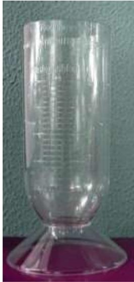
Figura 38. Pluviómetro. Embudo sobre probeta. Fuente: valkanik.com
