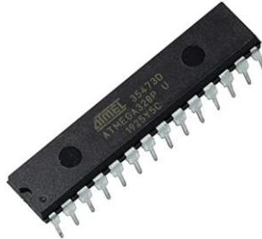
Figura III.4 - Encapsulado THT del microcontrolador ATmega328P
