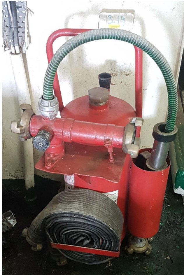
Ilustración 35. Dispositivo Portátil Lanza espuma. Fuente Propia.
