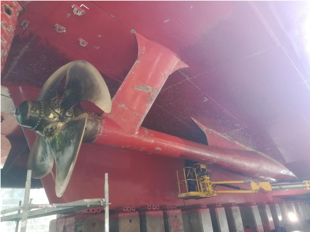
**Figura A.2:** Vista en detalle de una de las CPP del buque *Passió Per Formentera* (Fotografía tomada por el alumno durante su período de prácticas a bordo).
