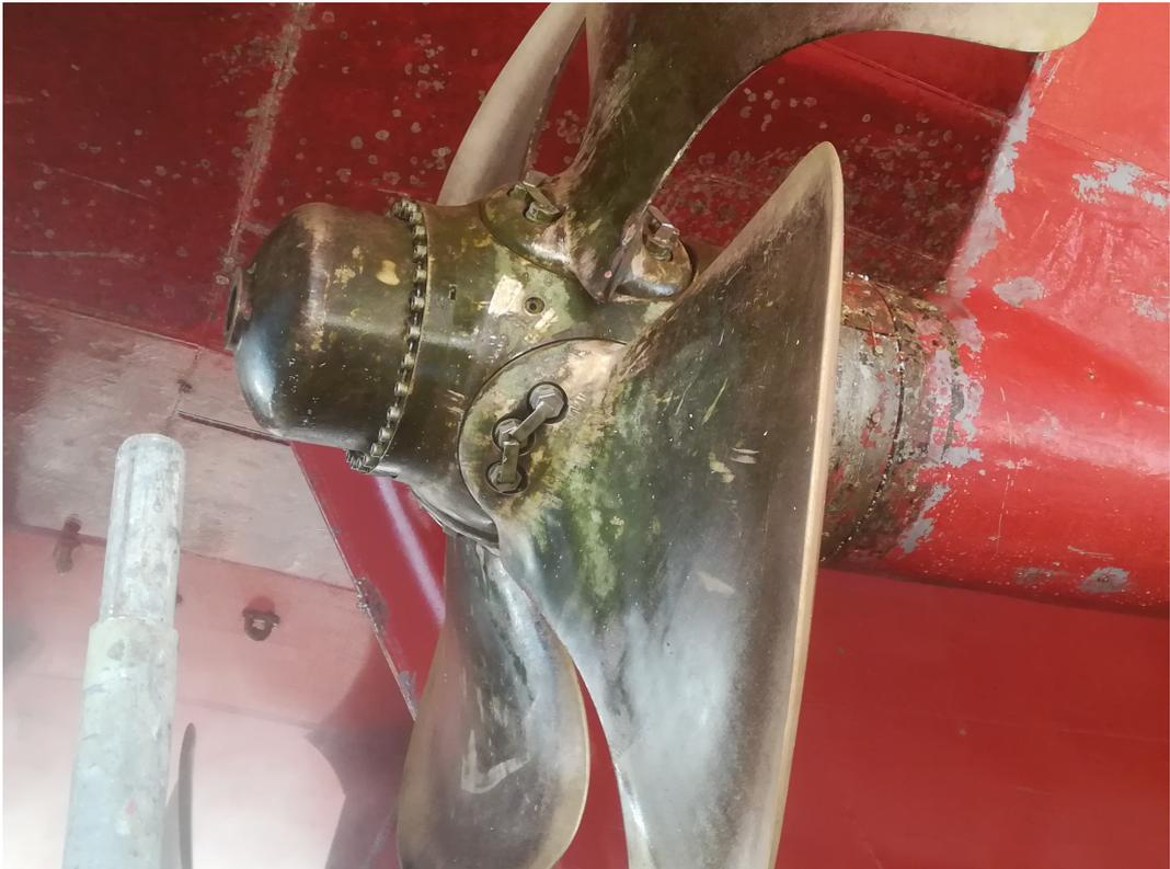
**Figura A.3:** Vista en detalle de una de las CPP del buque *Passió Per Formentera* (Fotografía tomada por el alumno durante su período de prácticas a bordo).
