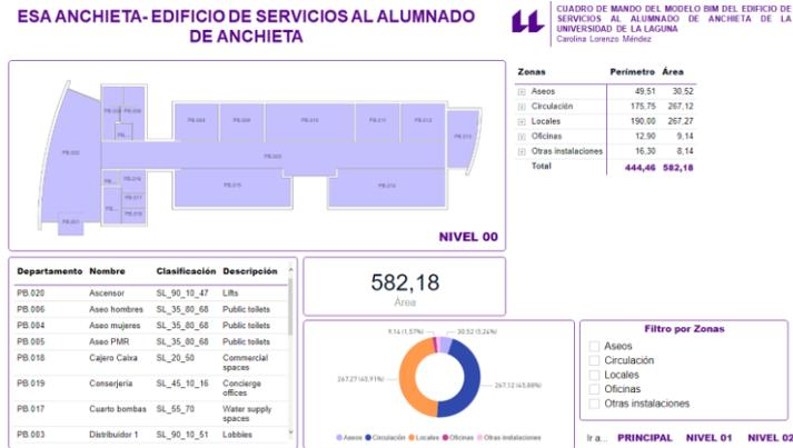
Figura 40: Vista de cuadro de mandos NIVEL 00 de un modelo BIM
