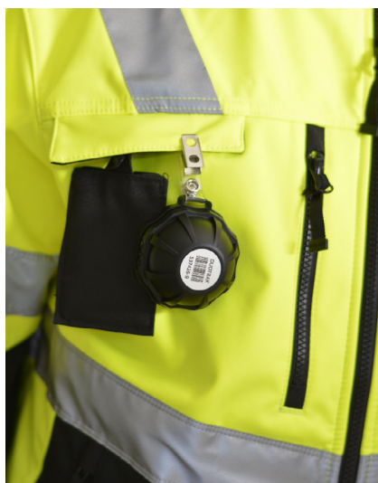
Figura 13. Dosímetro de radón de solapa. Fotografía cortesía de Radonova Laboratories
