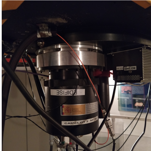
Figura 2: CAMELOT2 en el foco Cassegrain del IAC80. Foto de Manuel Sánchez Benavente.
