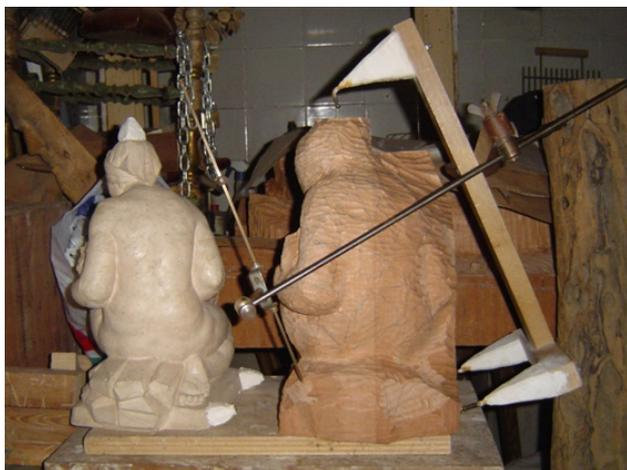
Figura 2. Máquina de sacar puntos o puntómetro (Fuente: Wikimedia Commons).
