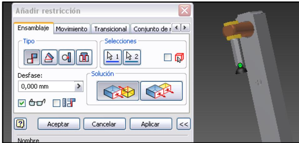
Figura 4.23. Asignación del segundo punto y final de la coincidencia
