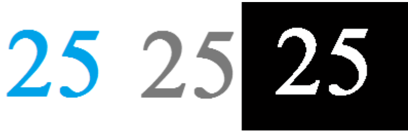
Figura 2.8: Proceso de binarización de una imagen
