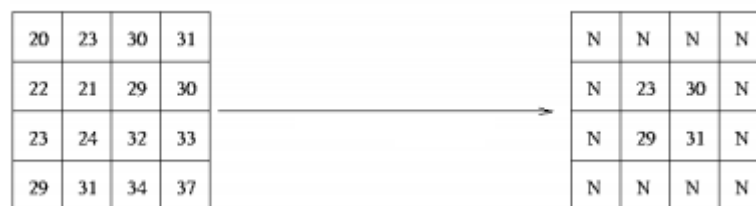
Figura 2.5: Funcionamiento del filtro de mediana. Fuentes imagenes-uisrael.blogspot.com
