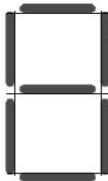
Figura 2.17: Líneas extraídas de un número en 7 segmentos
