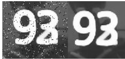
Figura 2.6: Ejemplo de aplicación del filtro de mediana
