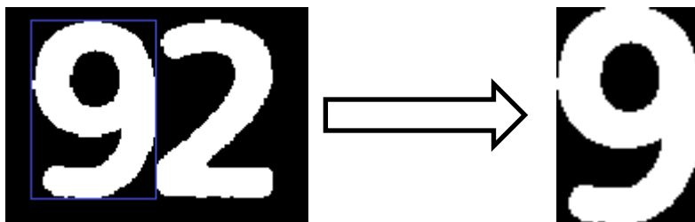
Figura 2.12: Número cortado con el uso del “ boundingbox ”
