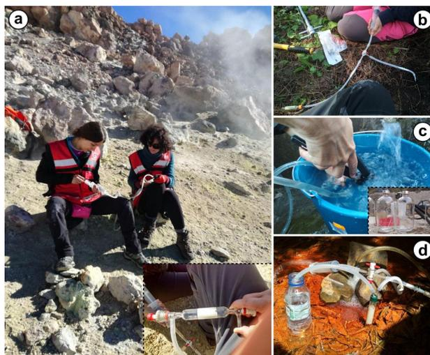
Figura 3.6: Toma de muestras de gases fumarólicos y detalle de la ampolla de almacenamiento de la muestra (a), muestreo del gas del suelo (b), toma de muestras de gases disueltos y vista en detalle de las botellas de almacenamiento (c) y ejemplo del muestreo de gases libres mediante el método del embudo invertido (d).
