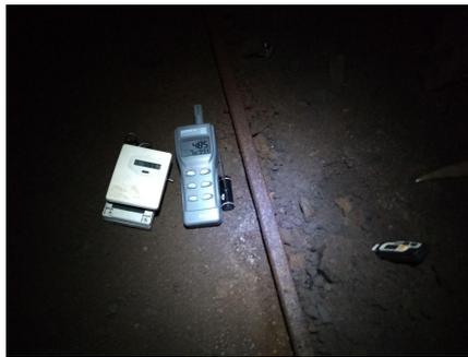
Figura 5.2: Medida de las temperaturas ambiente y del suelo, y de la concentración de CO<sub>2</sub> durante uno de los perfiles llevados a cabo en el interior de la galería RdG en Tenerife.
