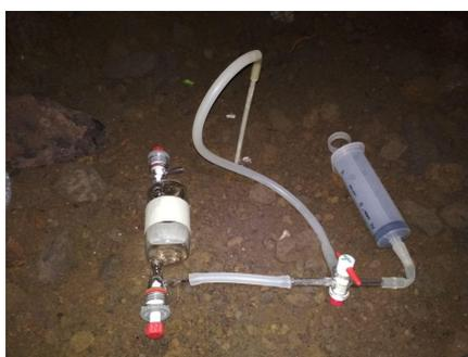
Figura 5.3: Toma de muestras de gas del suelo en el interior de la galería RdG.
