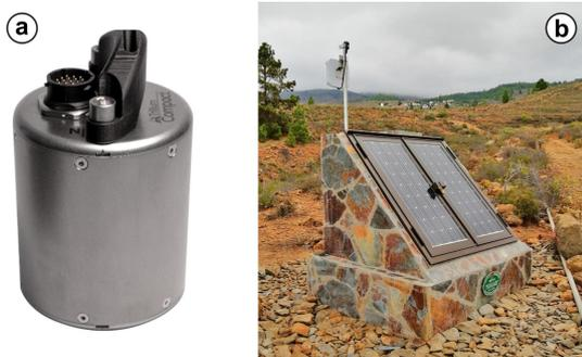
Figura 3.2: Ejemplo de sismómetro de banda ancha (a) y de estación sísmica operativa (b) (CADE en Tenerife perteneciente al IGN).
