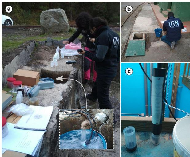
Figura 3.8: Toma de muestras de agua y medida de los parámetros fisicoquímicos en dos galerías de Tenerife (a) y (b). Sonda multiparamétrica para el seguimiento en continuo de los parámetros fisicoquímicos del agua (c).
