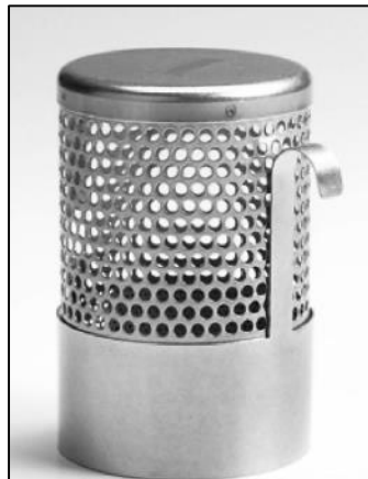
Figura 6.2. Apariencia aproximada del recipiente con carcasa de rejilla del interior del equipo de maceración.
