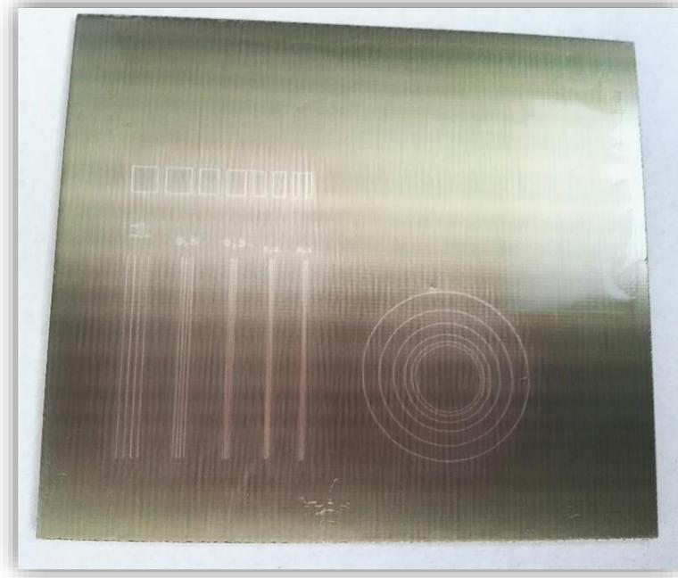
*Figura 7.9. Resultado. Separación entre líneas sobre placa fotosensible.*
