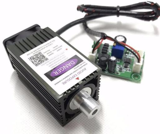
*Figura 3.6. Disipador de calor y circuito de control del láser.*
