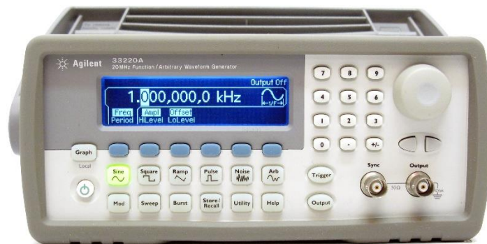
Figura 18: frontal del generador de funciones Agilent 33220A.
