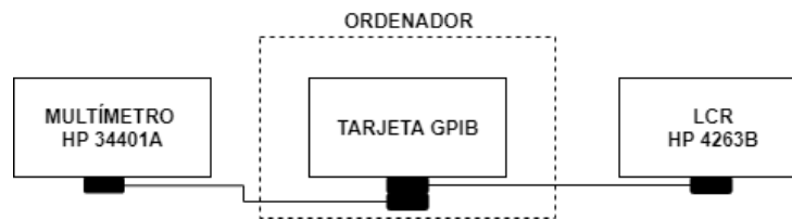
Figura 32: esquema de conexión entre los instrumentos y el ordenador.
