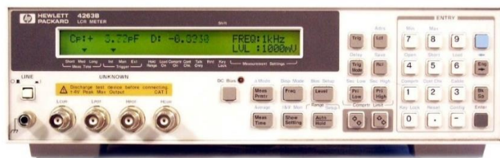
Figura 6: panel frontal del medidor de impedancias HP 4263B.
