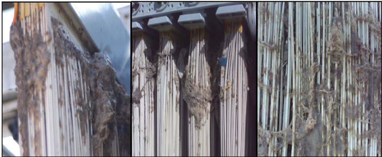
Figura 2.6. Efecto del ensuciamiento sobre membranas sumergidas de fibra hueca (Delgado et al., 2011).
