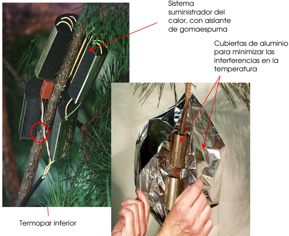
Foto IV. 2. Sensores utilizados para el seguimiento del flujo de savia en planta entera.
