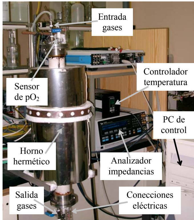
Fig.3.2.8. Horno de atmósfera controlada utilizado durante el trabajo de investigación.
