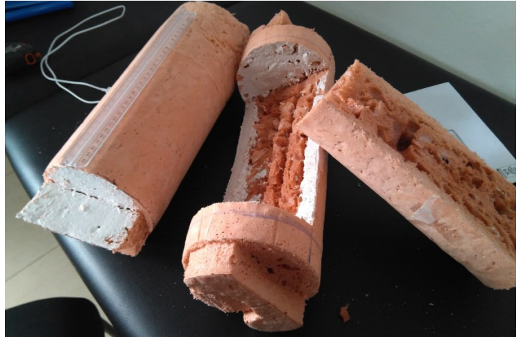
Ilustración 17. Primeras capas macilla en el poliuretano. Fuente: Elaboración propia.
