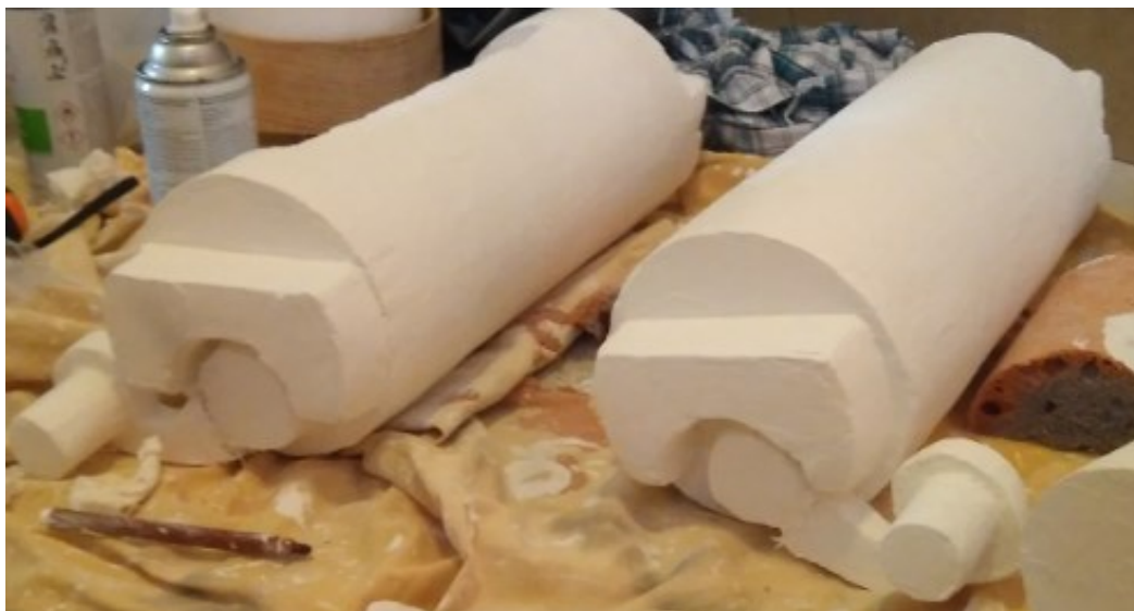
Ilustración 19. Poliuretano capa final de impresión. Fuente: Elaboración propia.
