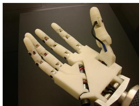
Figura: resultado aproximado del montaje de la mano
