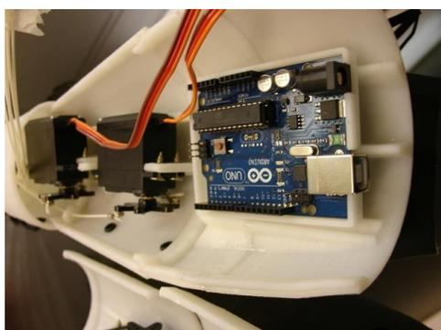
Figura: Servos y Arduino dentro del brazo de Gael\_Langevin, Thingiverse
