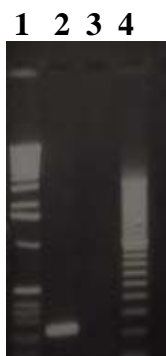
Figura 3.2.5b: Electroforesis en gel de agarosa al 1'5% del producto de amplificación por PCR.
