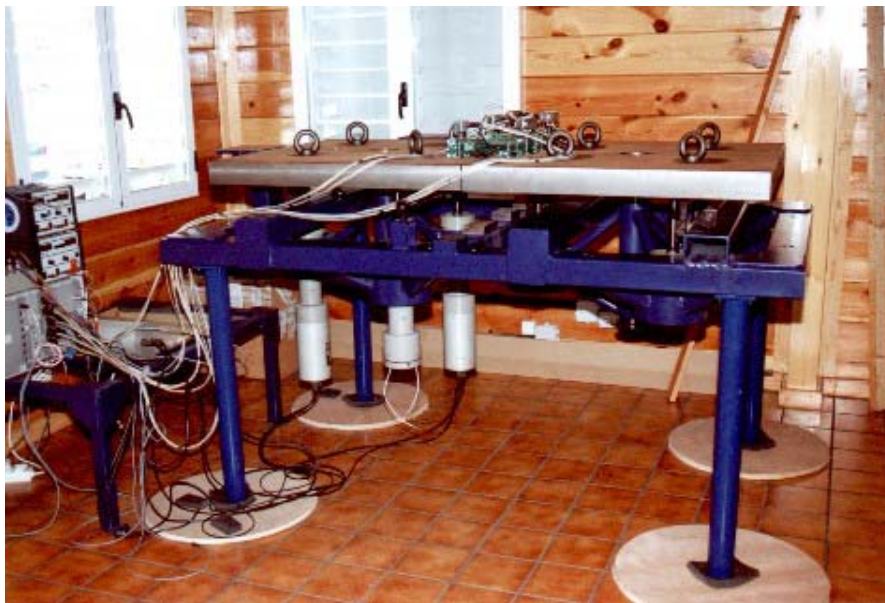
Figura 8.1: Vista general de la maqueta del espejo primario del GTC, en la cual se observan los actuadores conectados a uno de los dos segmentos.
