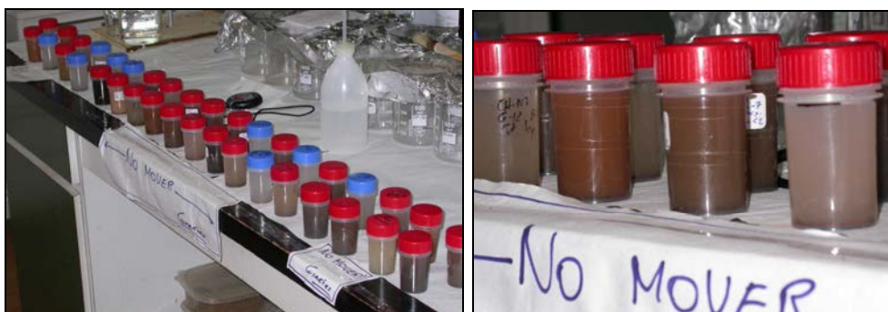
Figuras 217 y 218 , Recipientes con muestra en suspensión enrasada a 40 ml., con arcillas en suspensión tras sesión de ultrasonidos. J.A.
