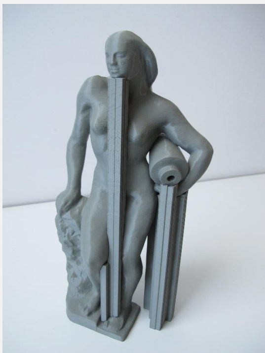
Figura con los soportes de impresión FIG. 53 FIG. 54ab Detalles de soportes de impresión
