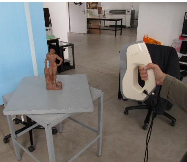
Toma de datos con el escáner Eva FIG. 17
