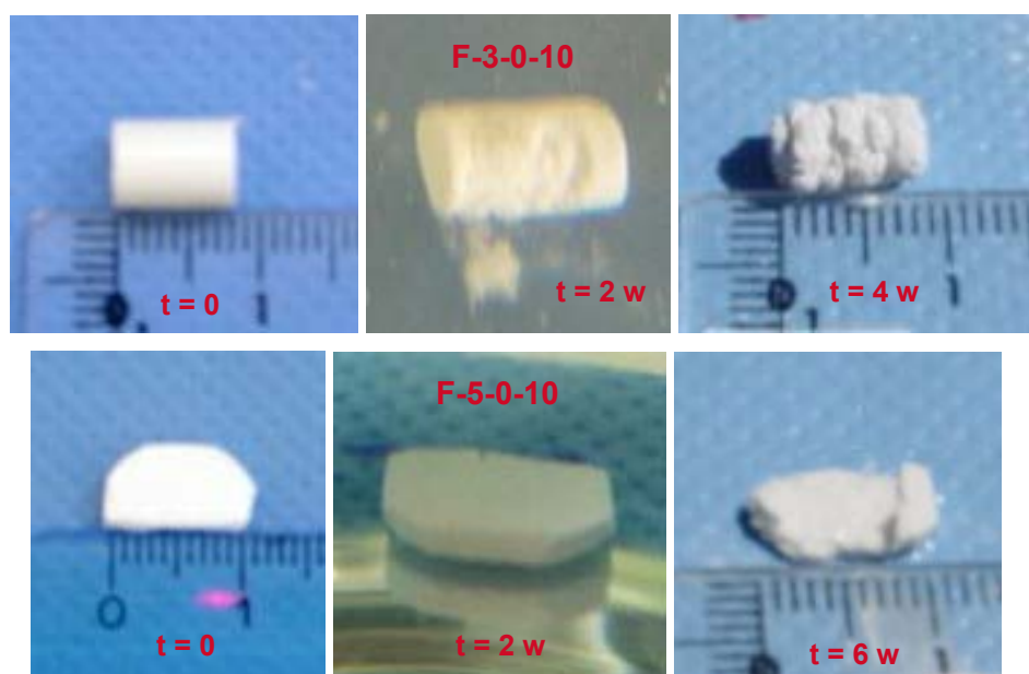
Figura 77.- Efecto de la presión. Cambios morfológicos producidos en los implantes F-3-0-10 y F-5-0-10 a lo largo de los ensayos de cesión.
