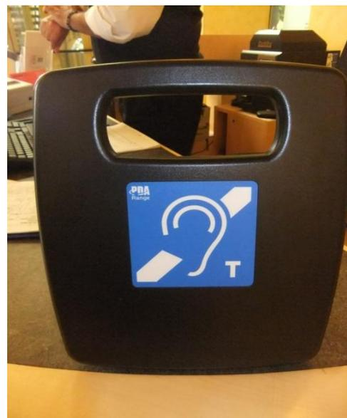
Figura 22: Vista trasera del bucle magnético portátil. Fuente: Elaboración propia.
