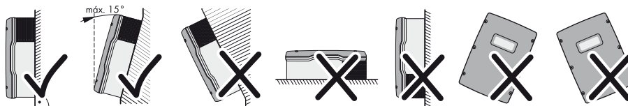
Imagen 5: Posiciones de montaje permitidas y no permitidas
