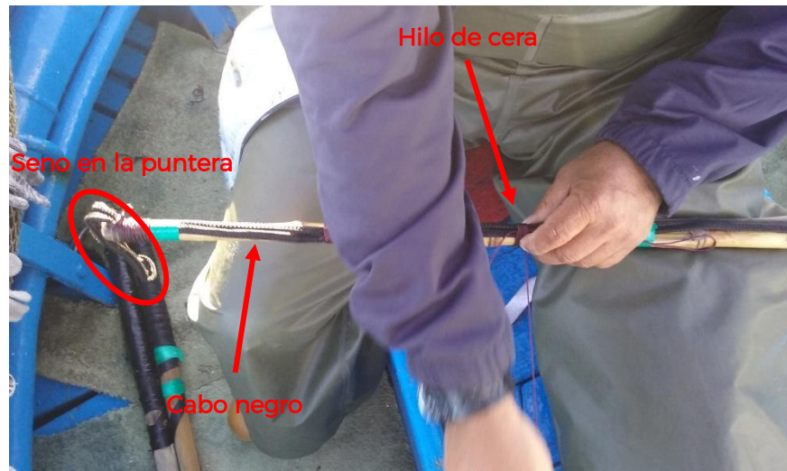
Ilustración 177. Pasos 1 y 2 realizados. Fuente: elaboración propia.
