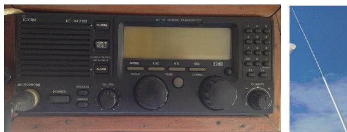
Ilustración 49. Radio MF/HF Marine Transceiver Icom IC-M710 y su antena correspondiente. Fuente: elaboración propia.
