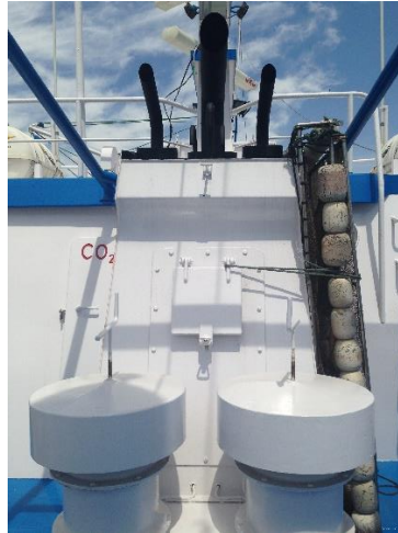
Ilustración 3.1. Extractores de los camarotes, extractor de la sala de máquinas y la salida de gases del motor principal y motores auxiliares. Fuente: elaboración propia.
