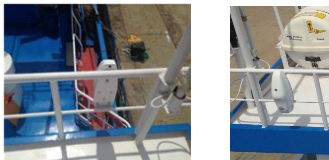
Ilustración 99. EPIRB ubicada en la toldilla del buque, vista posterior y anterior. Fuente: elaboración propia.
