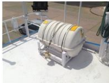
Ilustración 97. Balsa salvavidas ubicada en la parte superior del puente. Fuente: elaboración propia.
