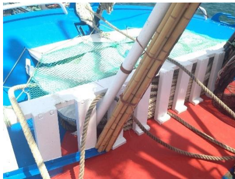
Ilustración 112. Cabo fondeo estibado en proa con protección y red para que no se vaya por la borda. Fuente: elaboración propia.
