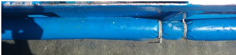
Ilustración 162. Protector de canillas relleno de espuma. Fuente: elaboración propia.
