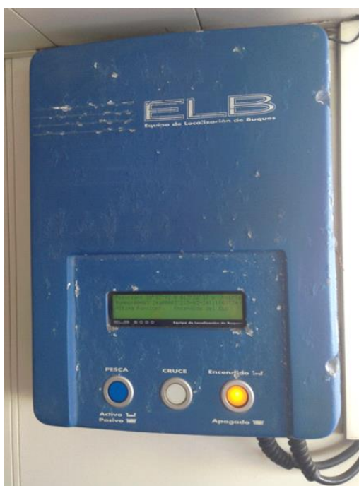
Ilustración 130. Equipo de Localización de Buques o Caja Azul. Fuente: elaboración propia.
