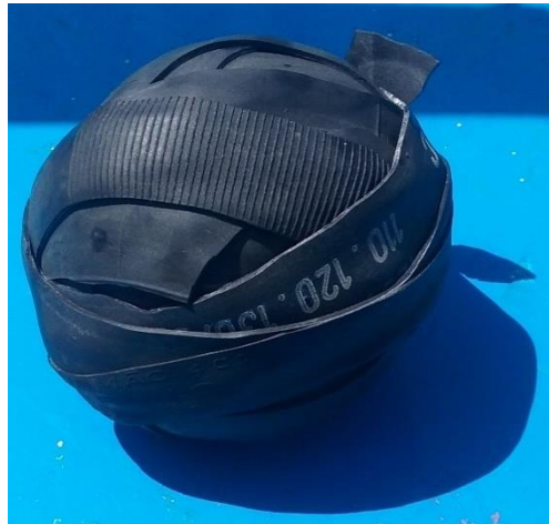
Ilustración 175. Goma ya recortada a la medida idónea y echa una bola para estibarla adecuadamente. Fuente: elaboración propia.
