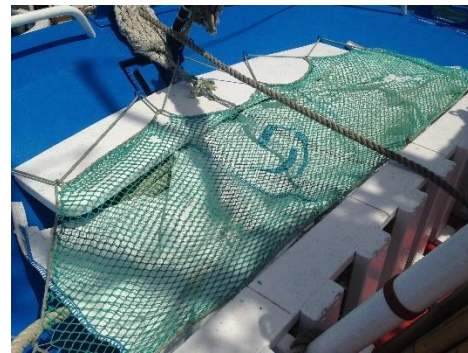
Ilustración 112. Cabo fondeo estibado en proa con protección y red para que no se vaya por la borda. Fuente: elaboración propia.
