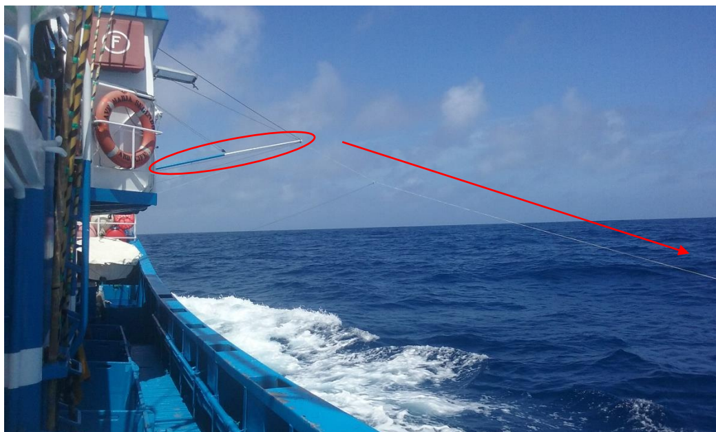
Ilustración 167. Se observa la pértiga de proa (óvalo rojo) y el aparejo en el agua (flecha roja). Fuente: elaboración propia.
