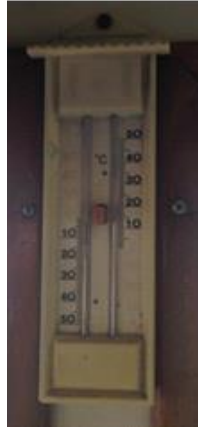
Ilustración 56. Termómetro de máxima y mínima del que dispone el buque. Fuente: elaboración propia.
