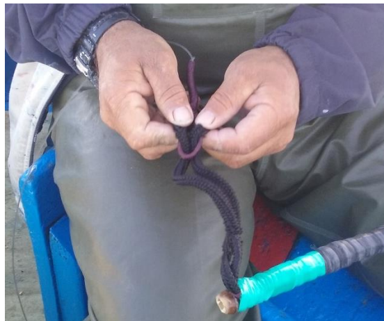
Ilustración 183. Uniendo aparejo y cabo negro mediante nudo llano. Fuente: elaboración propia.
