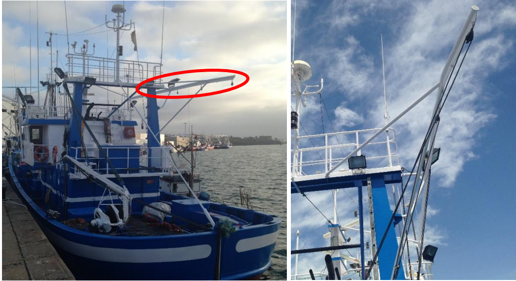
Ilustración 166. Poleas para ayudar a los pescadores a levar atunes de gran tamaño. Fuente: elaboración propia.
