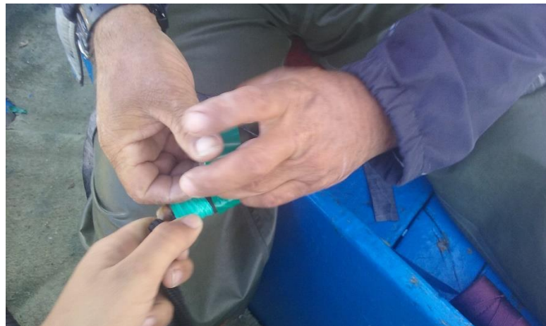
Ilustración 180. Colocando cinta aislante a la goma de la puntera para que no se suelte. Fuente: elaboración propia.
