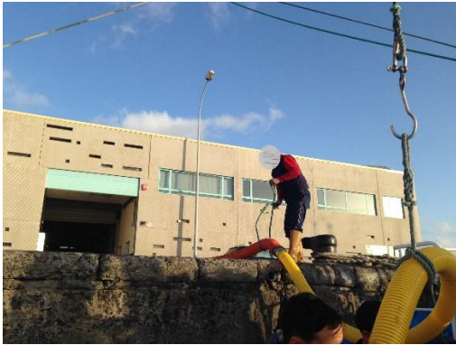
Ilustración 28. Toma en tierra para cargar el hielo a bordo e introducción del hielo en la nevera de proa respectivamente. Fuente: elaboración propia.
