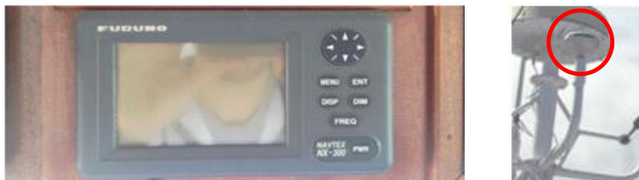
Ilustración 44. Display del sistema NAVTEX y su antena de trabajo. Fuente: elaboración propia.
