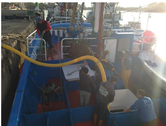
Ilustración 201. Introduciendo manguera en la nevera para recibir el hielo. Fuente: elaboración propia.
