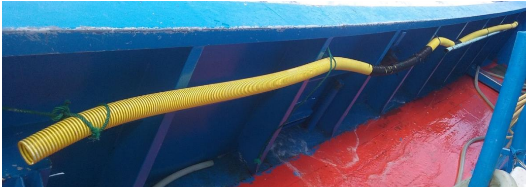
Ilustración 150. Manguera para la limpieza del fondo de los tanques. Fuente: elaboración propia.
