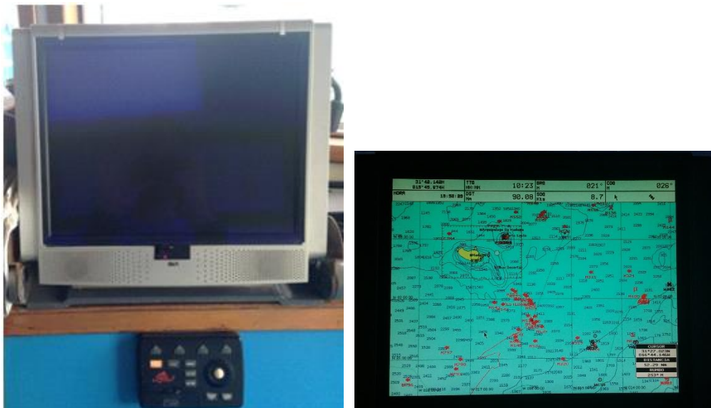
Ilustración 80. Carta electrónica SEIWA modelo Explorer 3. Fuente: elaboración propia.
