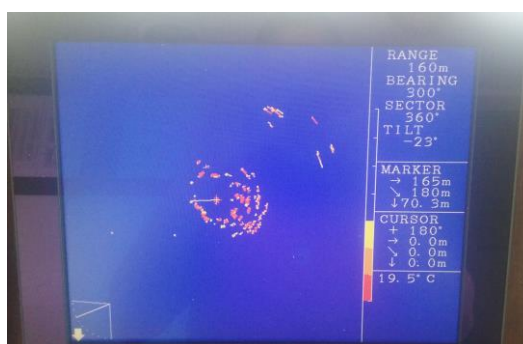
Ilustración 135. Esta fue tomada en diferente día a la anterior, como se observa, indica que el atún se encuentra mayormente por la banda de estribor y por la aleta de estribor. Fuente: elaboración propia.
