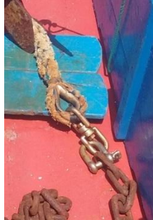
Ilustración 114. Grillete que une el cabo de fondeo y la cadena de fondeo. Fuente: elaboración propia.
