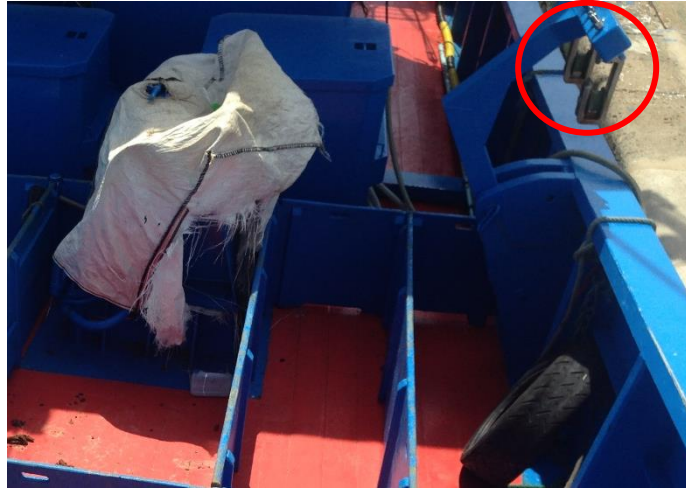
Ilustración 118. Poleas utilizadas para llevar el cabo de fondeo (pasteca). Fuente: elaboración propia.
