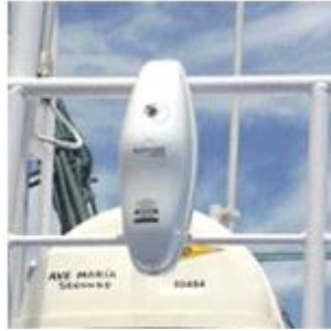
Ilustración 45. Radiobaliza EPIRB situada en el exterior del buque, concretamente en la toldilla del buque. Fuente: elaboración propia.
