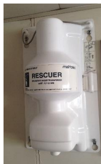
Ilustración 103. Transpondedor radar (SART) ubicado en el puente. Fuente: elaboración propia.
