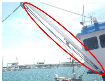
Ilustración 192. Pluma en la base del puente para arriar el bote. Fuente: elaboración propia.
