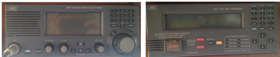
Ilustración 42. Radio de MF/HF, modelo JSB-196GM de JRC y equipo de DSC NCT-196. Fuente: elaboración propia.
