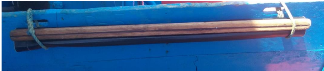
Ilustración 145. Toldo enrollado y estibado en su sitio. Fuente: elaboración propia.
