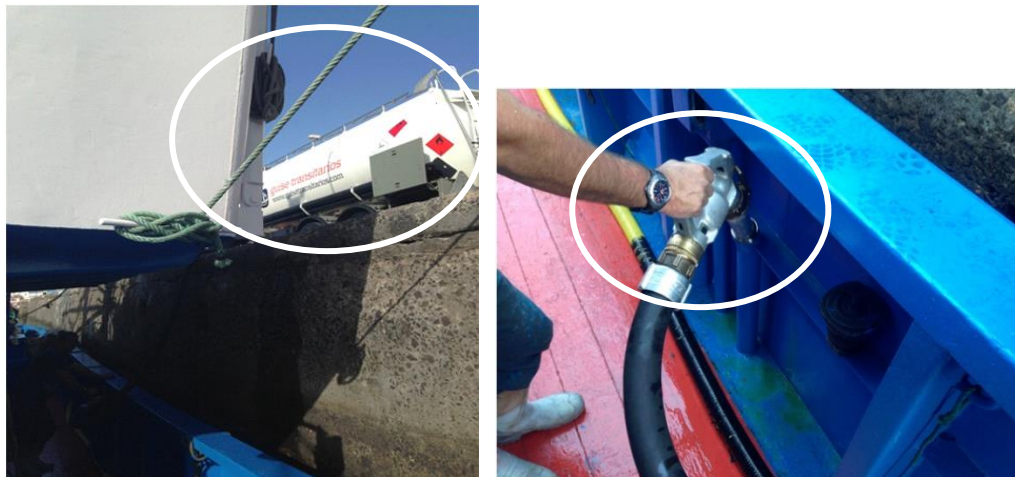
Ilustración 24. Camión que suministra el combustible y toma de llenado del buque respectivamente. Fuente: elaboración propia.
