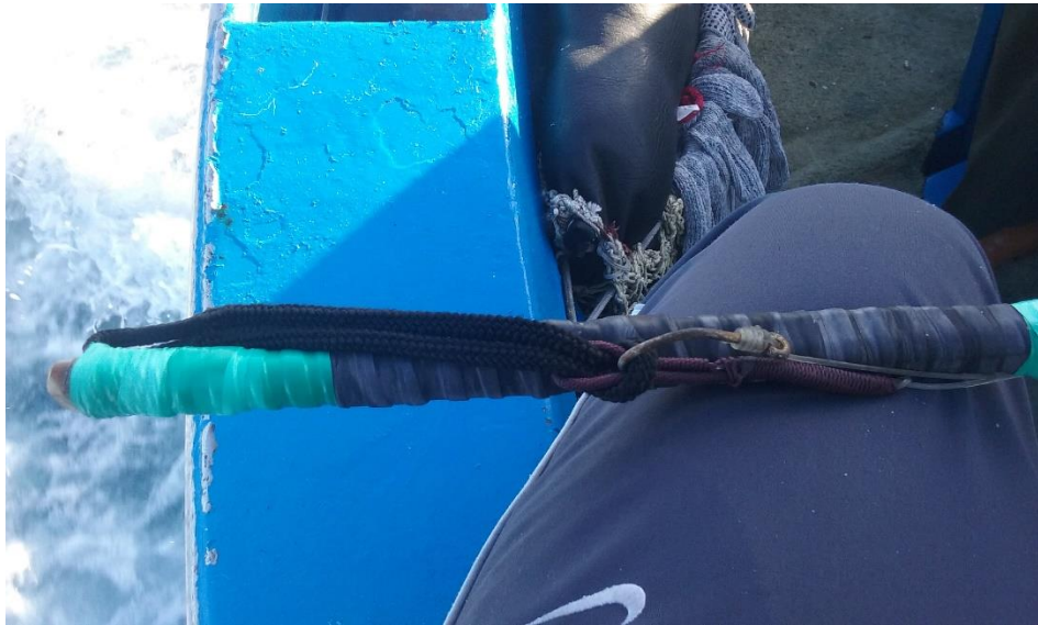
Ilustración 185. Apariencia de la puntera tras montar la caña. Fuente: elaboración propia.
