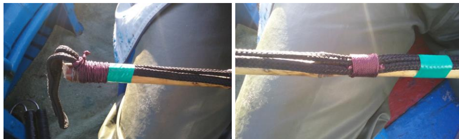
Ilustración 178. Resultado del calafateo al cabo negro. Fuente: elaboración propia.
