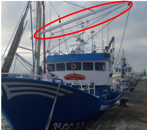
Ilustración 111. Pluma de proa y gancho de la misma. Fuente: elaboración propia.
