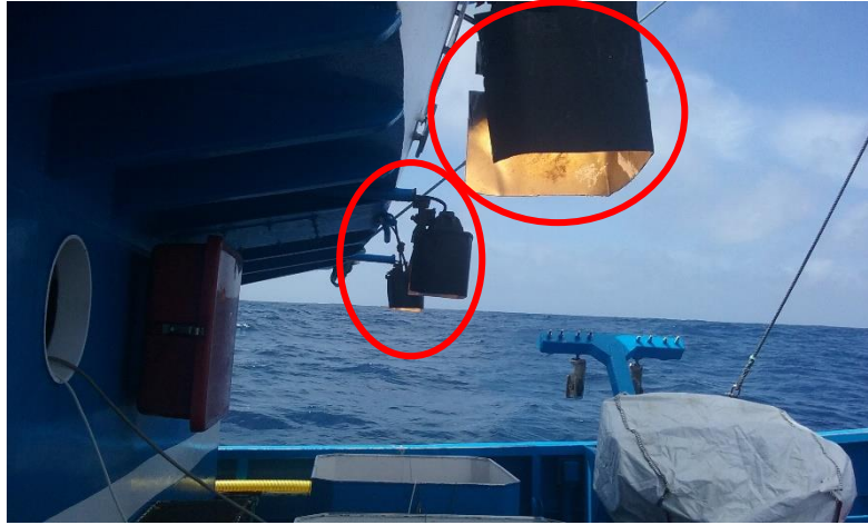
Ilustración 141. Luces que enfocan a las bocas de los tanques para iluminarlos. Fuente: elaboración propia.
