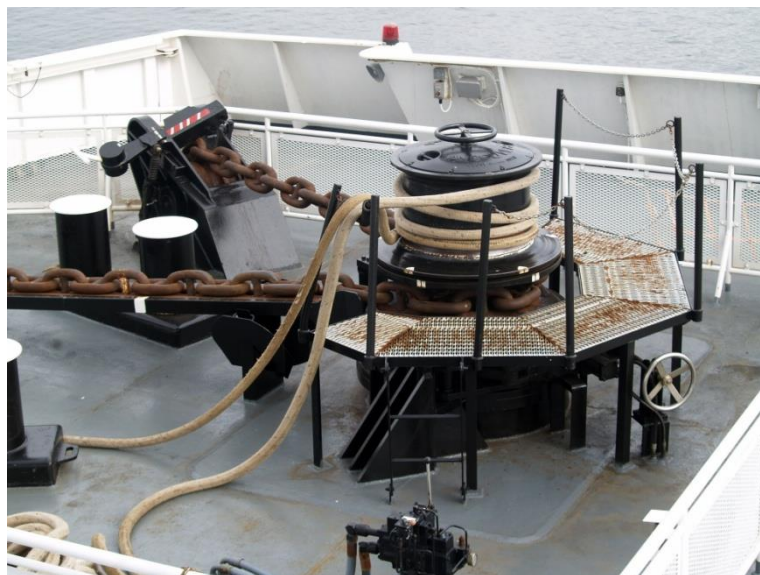
Ilustración 6. Cabrestante de proa. Fuente: nauticexpo.it
