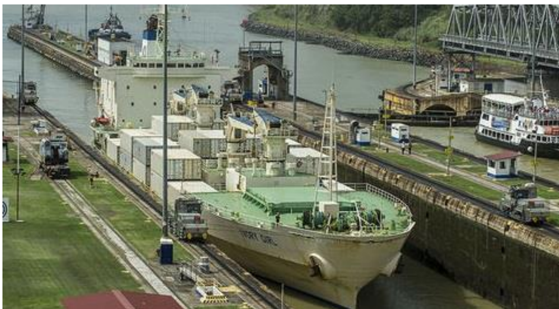
Ilustración 39. Buque amarrado a vagones móviles sobre raíles. Fuente: elespanol.com
