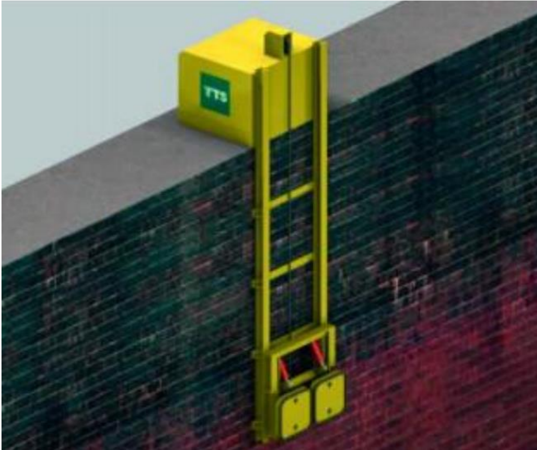
Ilustración 82. Instalación portuaria de dispositivo de amarre por vacío.
