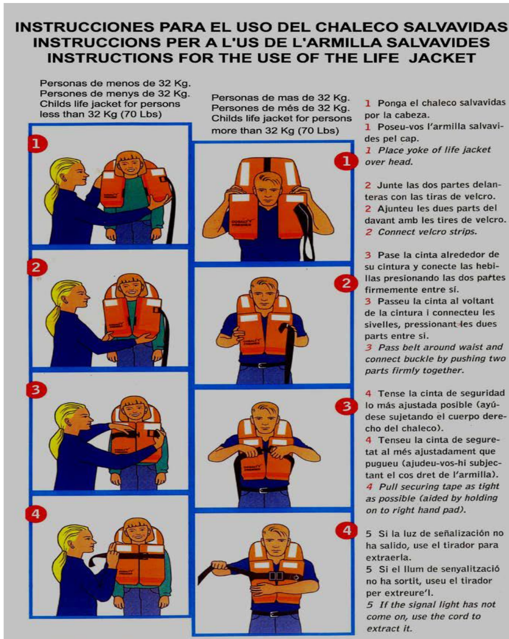
Imagen 15. Instrucciones del chaleco salvavidas. Fuente: Apuntes de Seguridad, Contraincendios y Supervivencia en la Mar.
