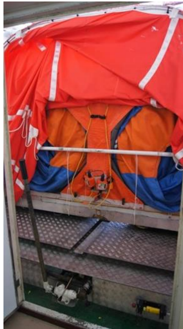
Imagen 6. Estiba del sistema M.E.S. Fuente: Trabajo de campo.
