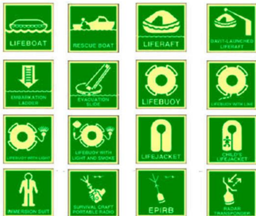
Imagen 12. Señalización de salvamento. Fuente: Apuntes de Seguridad Marítima, Contraincendios y Supervivencia en la Mar
