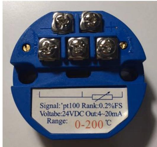
**Figura 4.4:** Conversor para termorresistencia PT-100.
