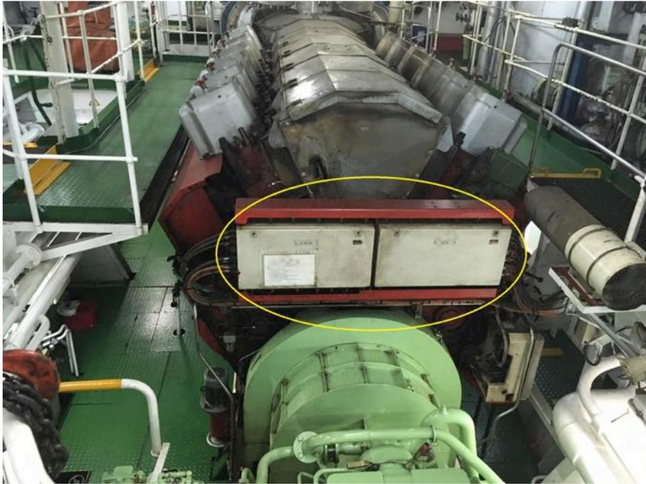
**Figura 5.1:** Vista de las cajas de conexiones de los sensores del motor.
