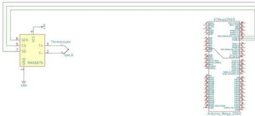
**Figura 3.3:** Comunicación módulo MAX 6675.
