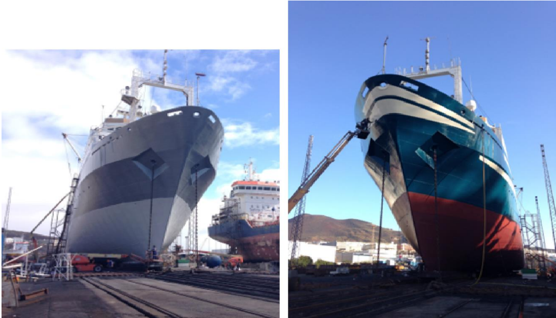
Ilustración 45: Jose Martí, a la izquierda capas iniciales de imprimación, a la derecha resultado final
