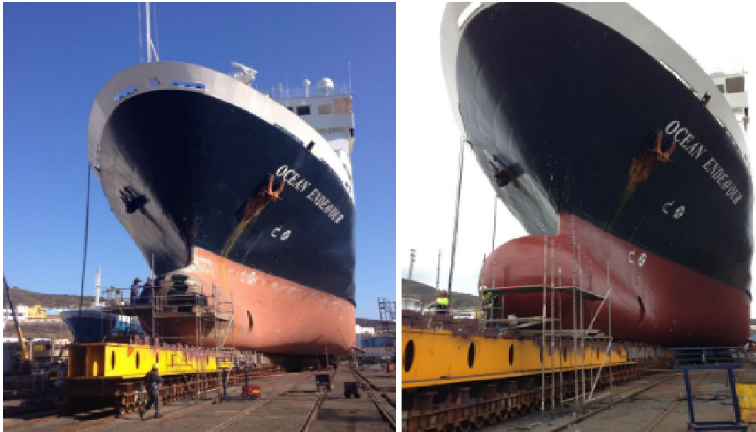
Ilustración 40: Ocean Endeavor, reparación del bulbo
