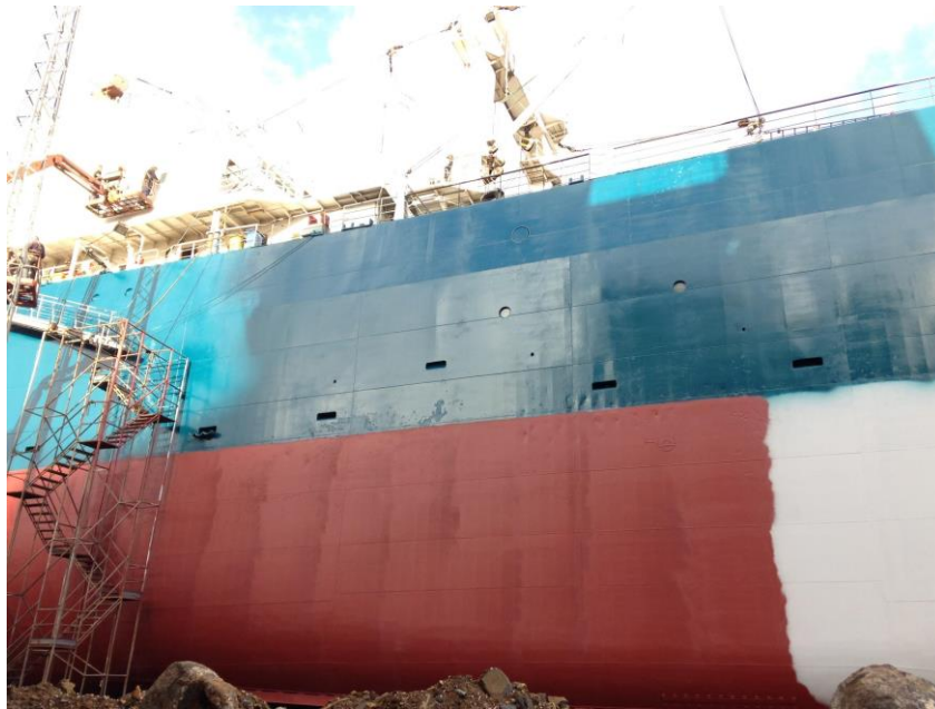
Ilustración 46: Jose Marti, realizando el pintado de acabado
