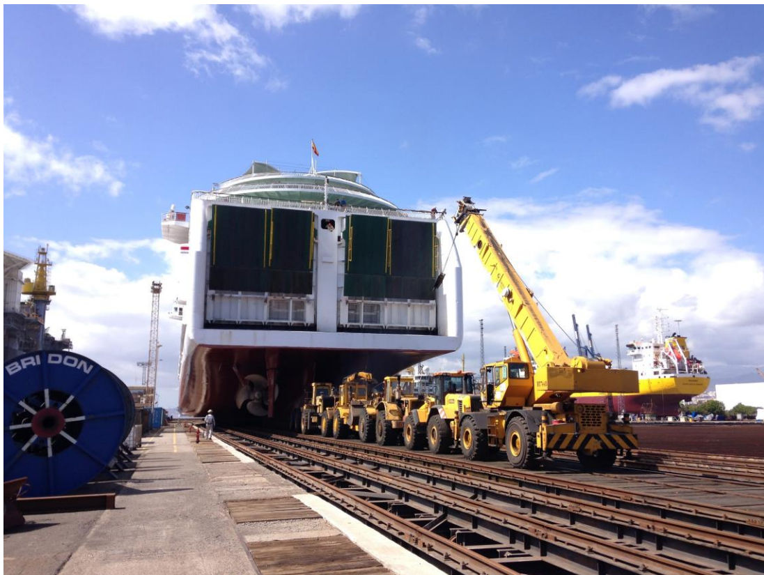
Ilustración 34: Volcán de Tamasite, empujado por cuatro remolcadores y una grúa
