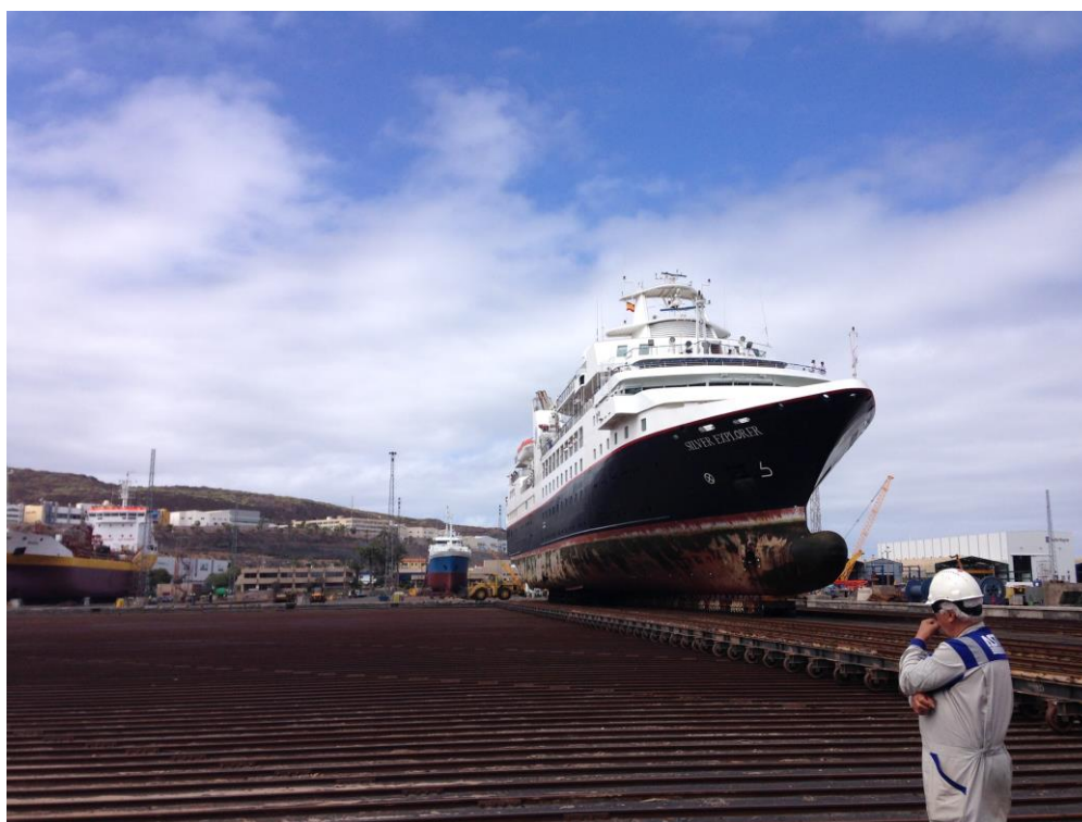
Ilustración 26: Jefe de maniobra supervisando la varada del Silver Explorer
