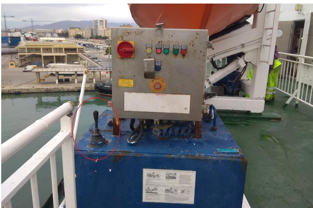
*Ilustración 97. Mandos de control del pescante del bote de rescate rápido. Fuente: Trabajo de campo.*
