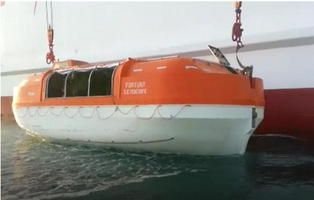
Ilustración 109. Secuencia de disparo en carga (ON LOAD) del bote salvavidas. Fuente: Trabajo de campo.
