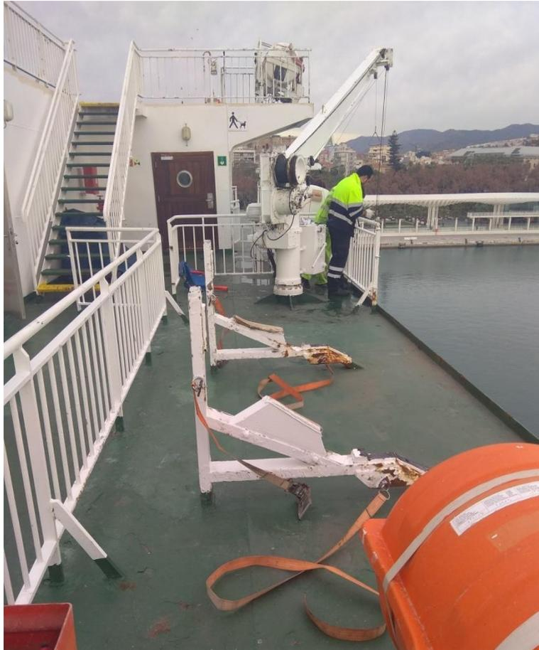
*Ilustración 83. Calzos (estiba) del bote. Fuente: Trabajo de campo.*
