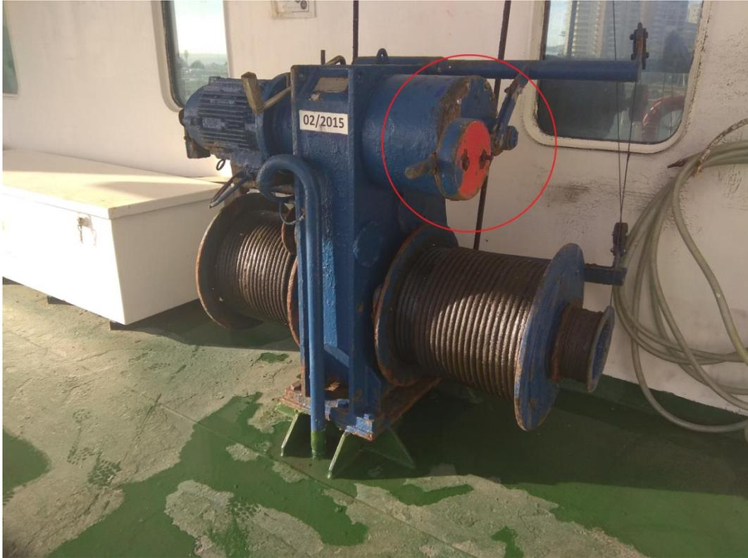
*Ilustración 107. Palanca de freno del pescante del bote salvavidas. Fuente: Trabajo de campo.*
