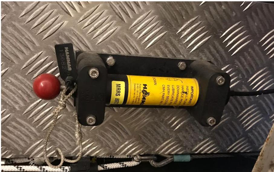
*Ilustración 39. Bomba de accionamiento del MES. Fuente: Trabajo de campo.*
