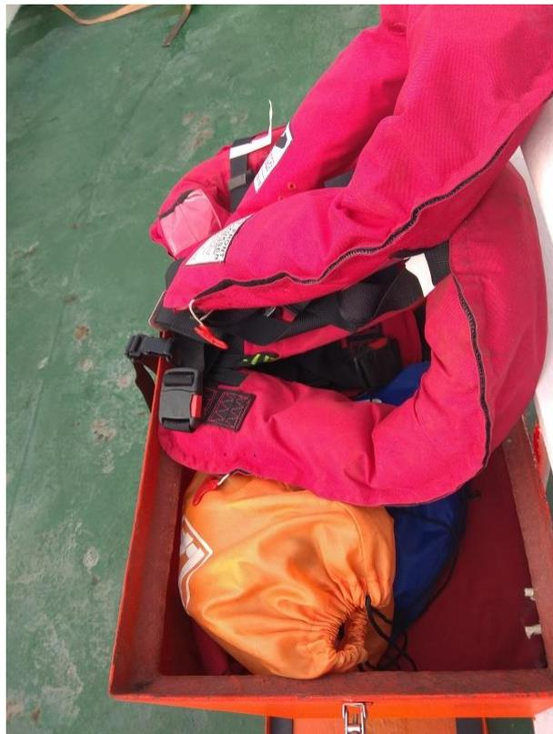
*Ilustración 24. Estiba de los trajes de inmersión junto al bote de rescate rápido. Fuente: Trabajo de campo.*
