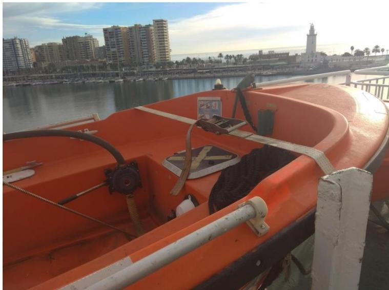
*Ilustración 16. Trincas de proa del bote de rescate. Fuente: Trabajo de campo.*
