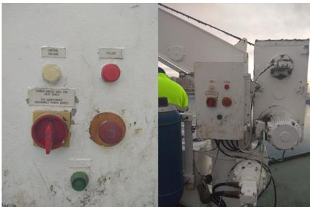
*Ilustración 85. Panel de control del pescante del bote. Fuente: Trabajo de campo.*
