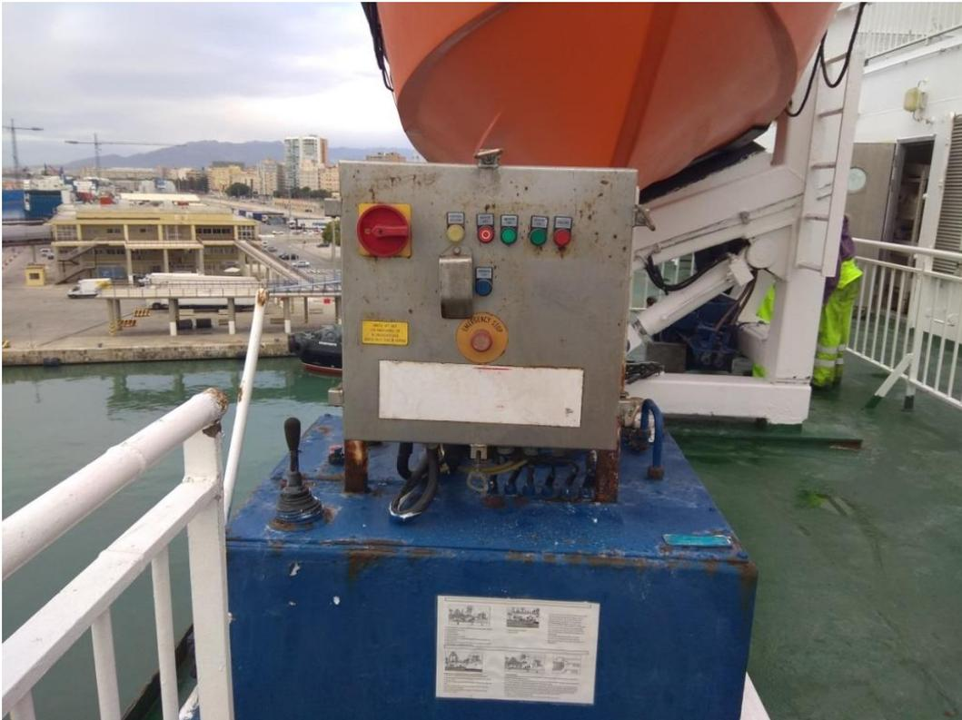
*Ilustración 26. Mandos del pescante del bote de rescate. Fuente: Trabajo de campo.*
