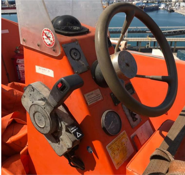
*Ilustración 99. Controles remotos del motor fueraborda del bote de rescate. Fuente: Trabajo de campo.*
