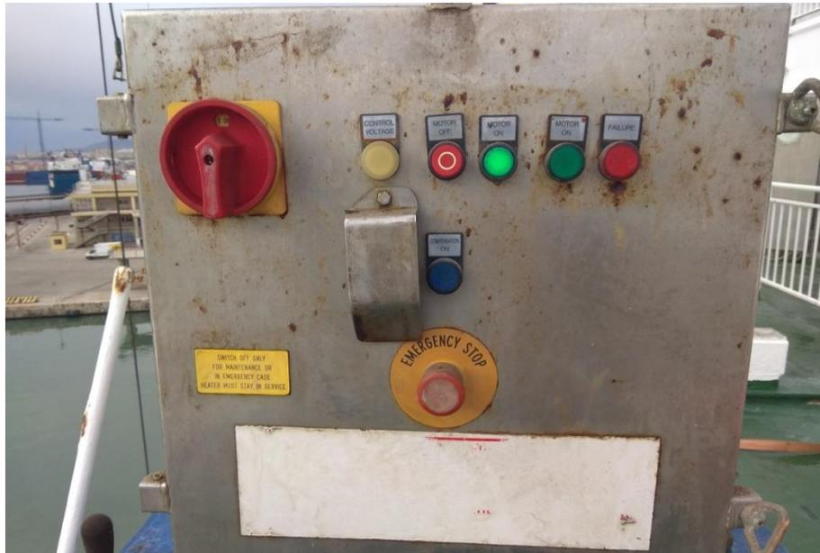
*Ilustración 95. Panel de control del pescante del bote de rescate. Fuente: Trabajo de campo.*
