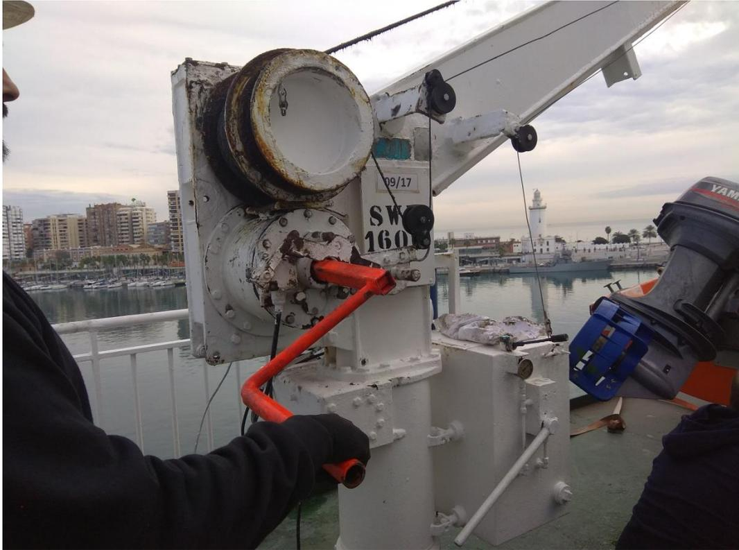
*Ilustración 81. Operario tensando el cable del bote de rescate. Fuente: Trabajo de campo.*
