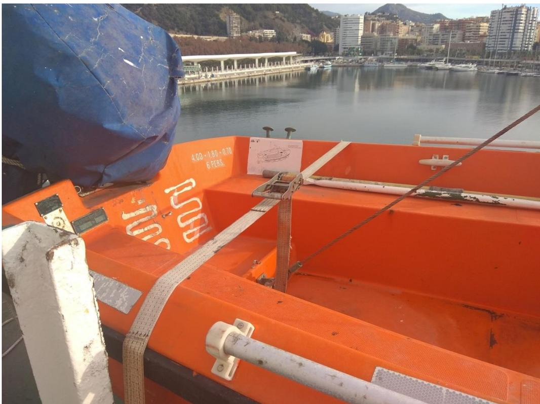
*Ilustración 82. Trincas de popa del bote de rescate. Fuente: Trabajo de campo.*
