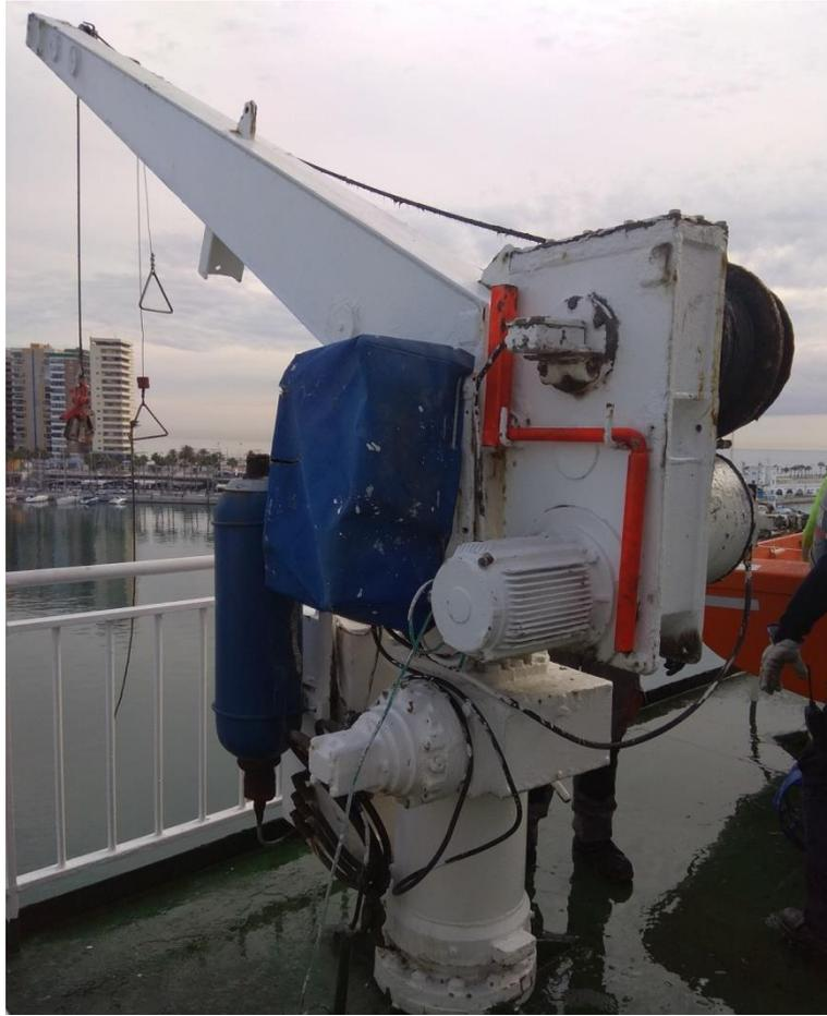
*Ilustración 15. Pescante con la manivela estibada. Fuente: Trabajo de campo.*
