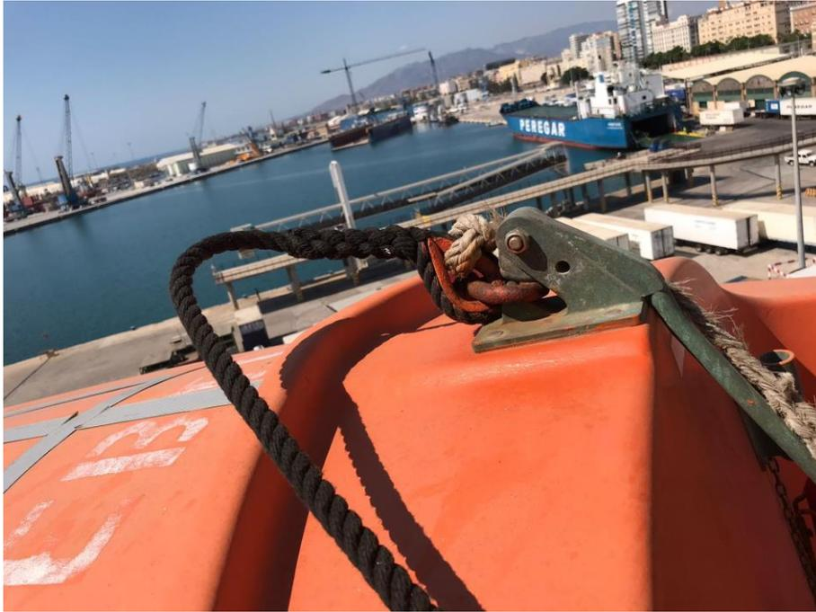
*Ilustración 101. Dispositivo de zafa de la boza del bote de rescate rápido. Fuente: Trabajo de campo.*
