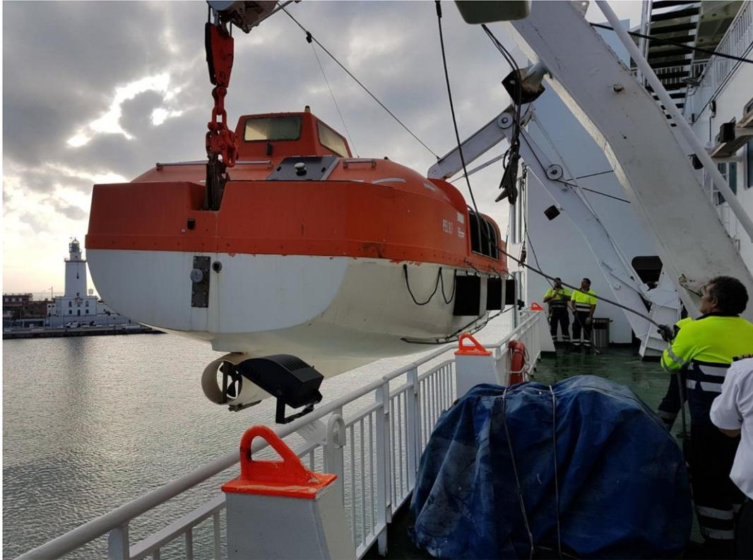
*Ilustración 105. Arriado del bote salvavidas hasta cubierta de embarque. Fuente: Trabajo de campo.*
