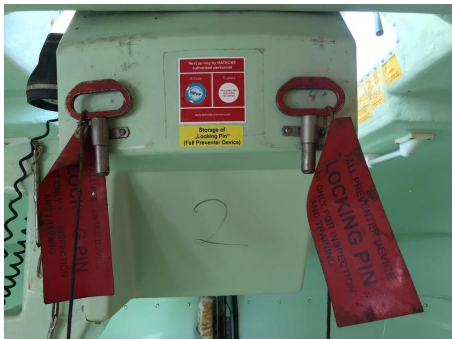
*Ilustración 103. Pines de seguridad del bote salvavidas estibados en el interior del mismo. Fuente: Trabajo de campo.*
