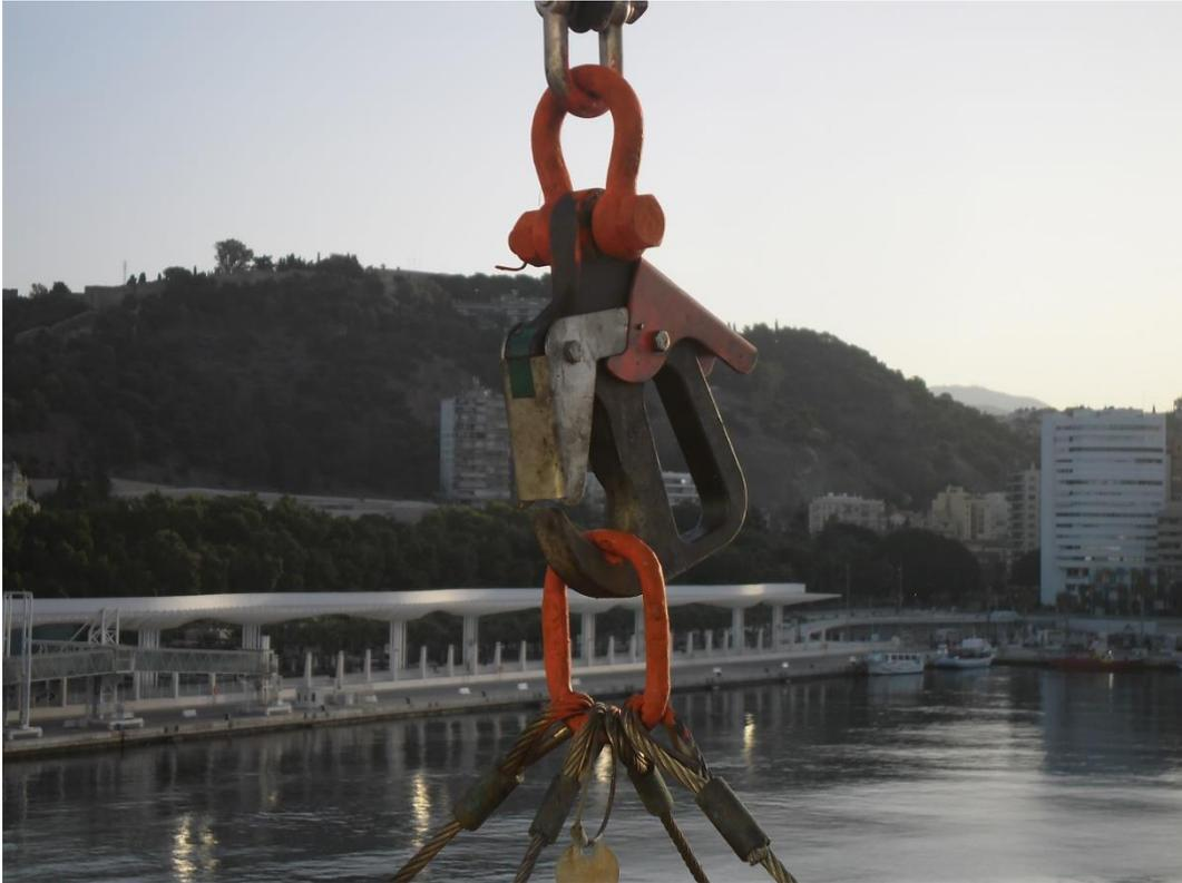
*Ilustración 90. Palanca (blanca para OFF LOAD) para la desconexión del bote. Fuente: Trabajo de campo.*
