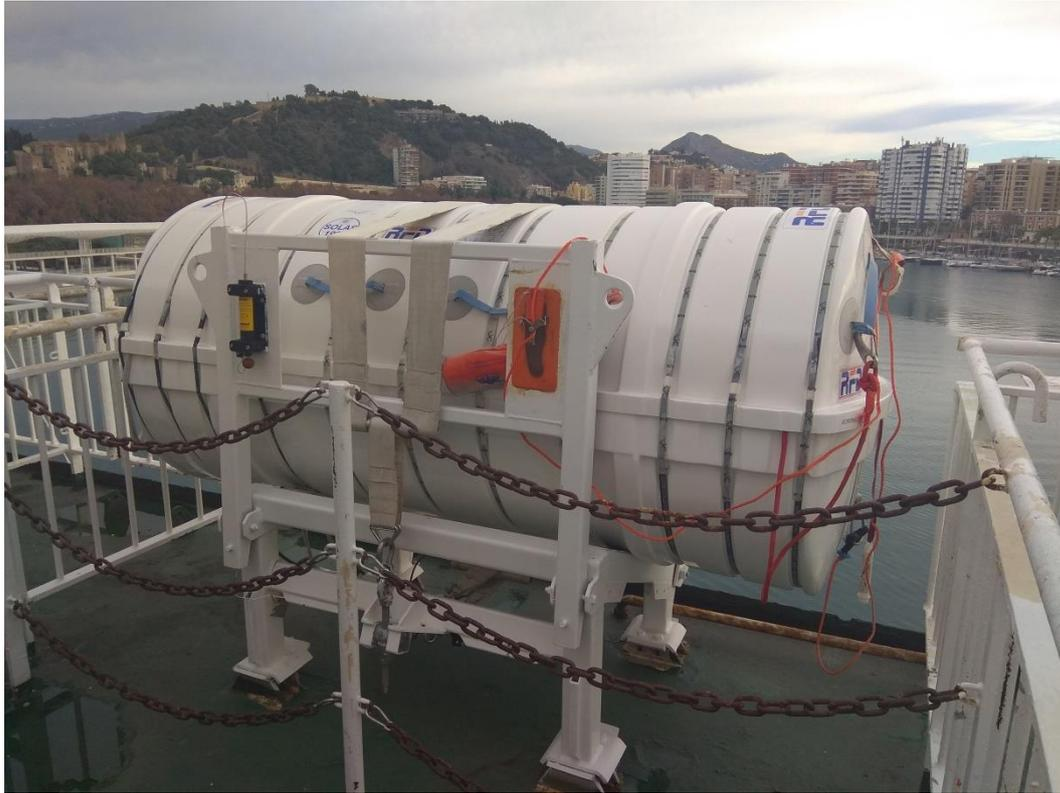
*Ilustración 36. Balsa de sobrecapacidad de la banda de babor. Fuente: Trabajo de campo.*
