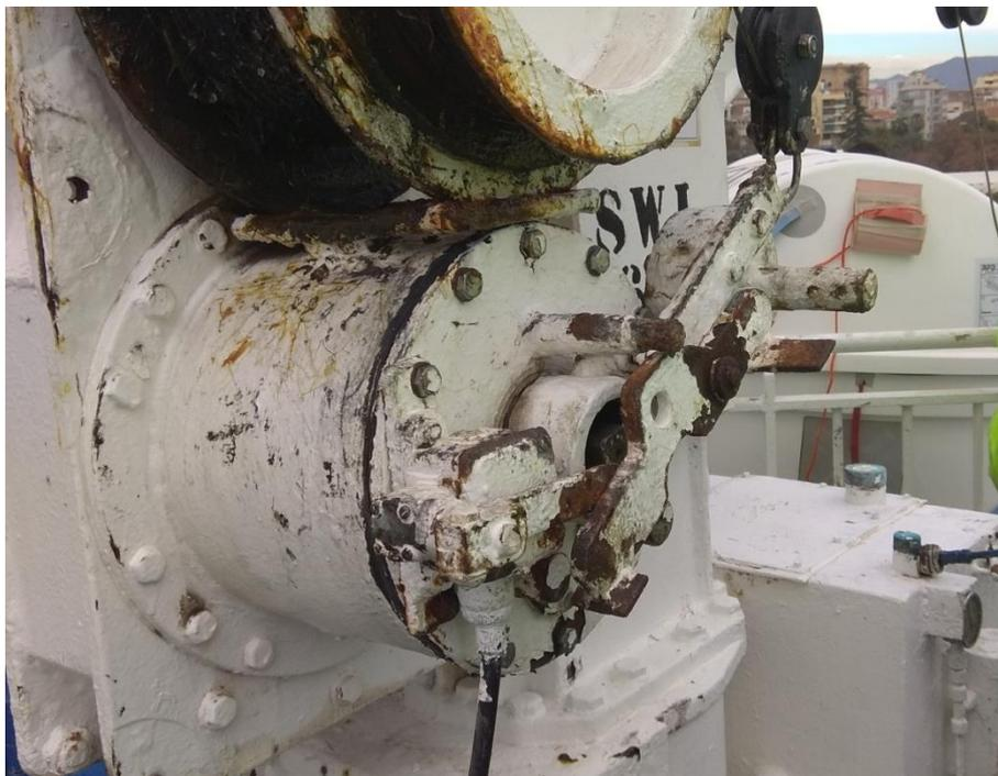
*Ilustración 19. Palanca del freno del pescante. Fuente: Trabajo de campo.*
