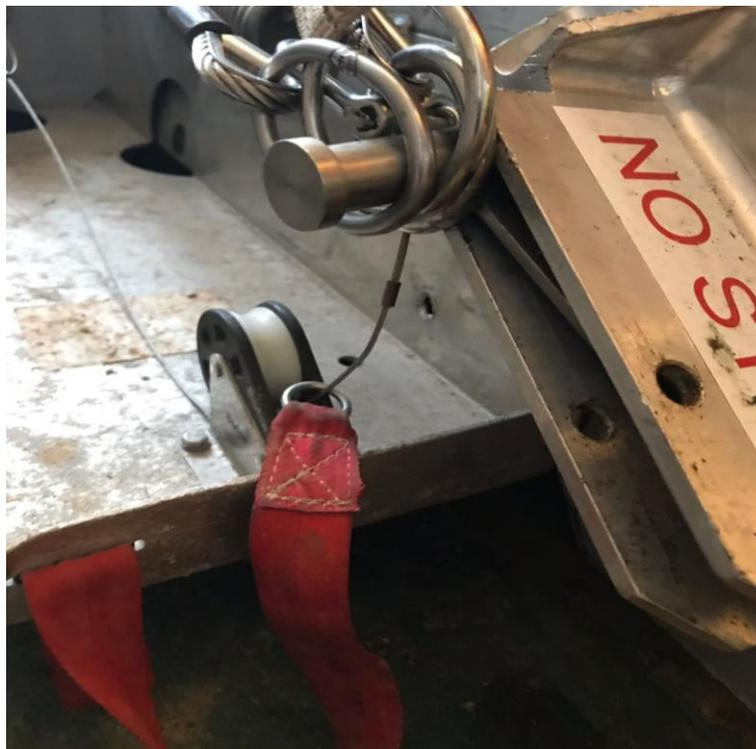
*Ilustración 44. Cordón rojo que permite la liberación de gas. Fuente: Trabajo de campo.*
