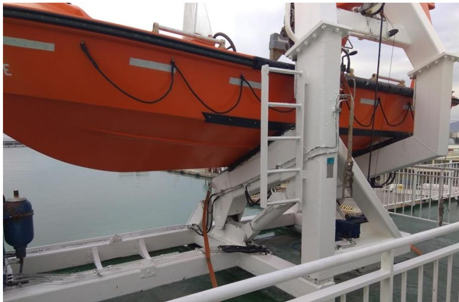
*Ilustración 96. Bote de rescate rápido destrincado. Fuente: Trabajo de campo.*
