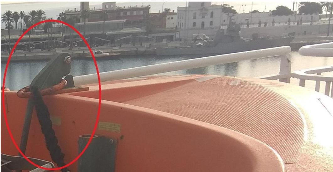
*Ilustración 91. Palanca de zafa de la boza del bote. Fuente: Trabajo de campo.*
