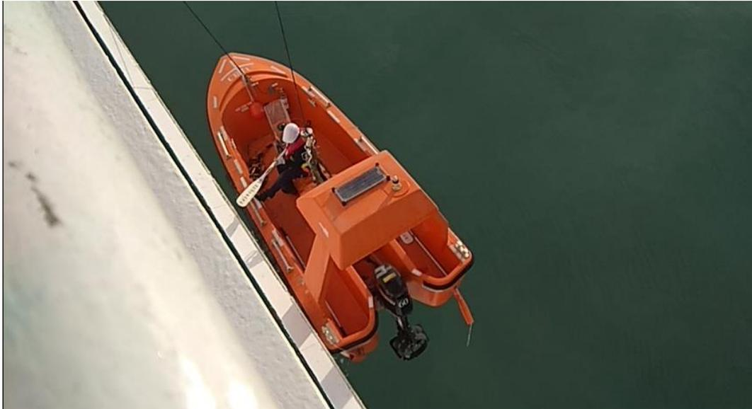
*Ilustración 98. Arriado del bote de rescate con el motor del pescante. Fuente: Trabajo de campo.*
