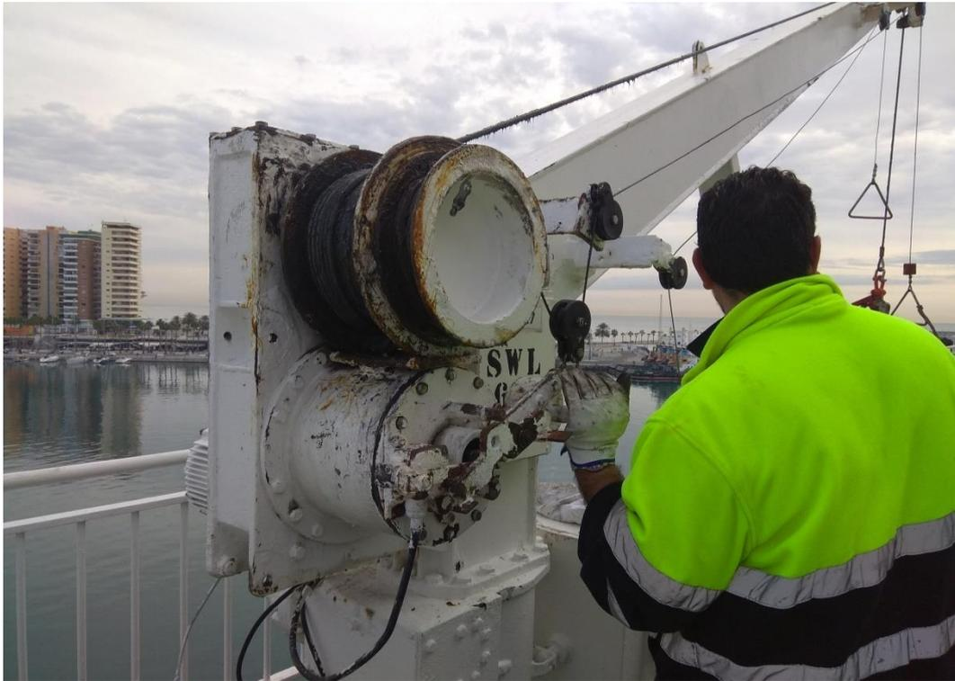
*Ilustración 87. Contramaestre levantando la palanca del freno. Fuente: Trabajo de campo.*
