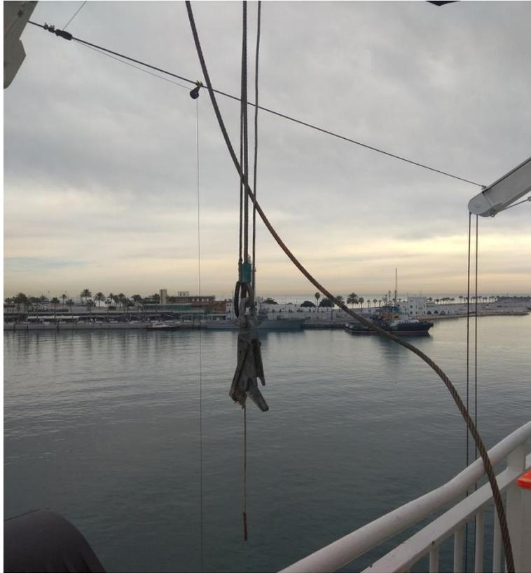
*Ilustración 104. Perigallo del bote salvavidas desenganchado durante arriado sin tripulación. Fuente: Trabajo de campo.*
