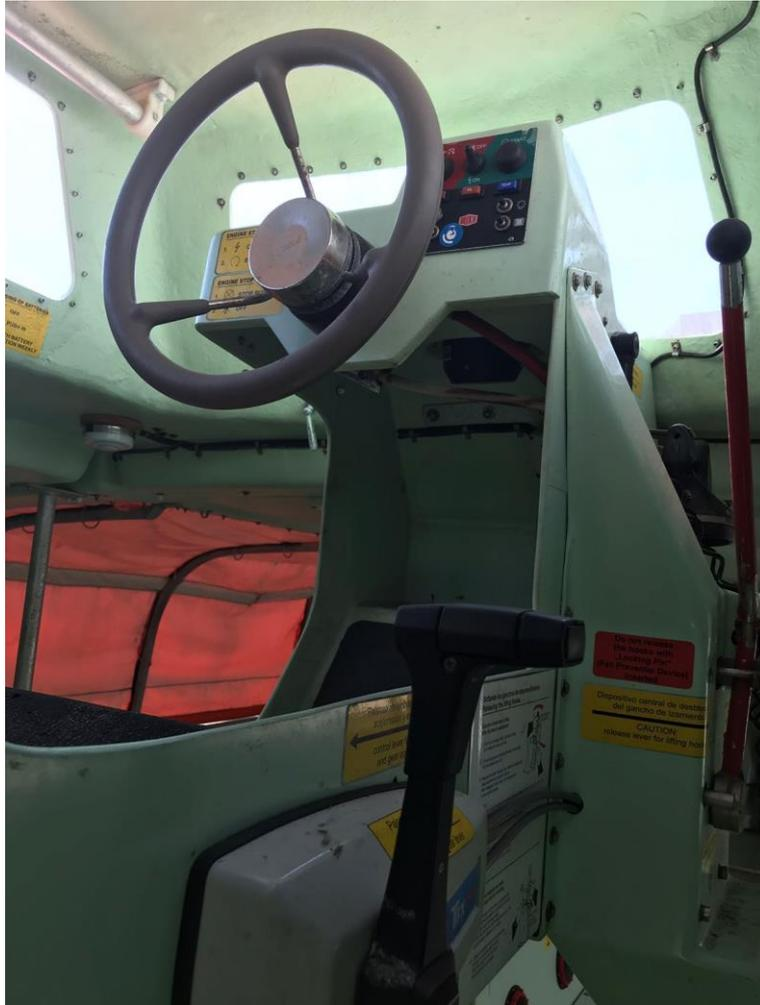
*Ilustración 108. Controles del timón y del motor del bote salvavidas. Fuente: Trabajo de campo.*
